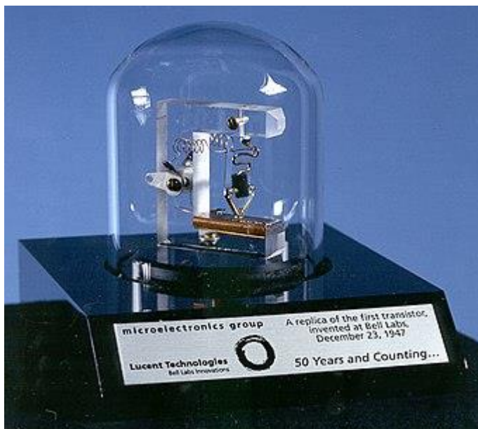
Перші транзистори на точкових контактах, продемонстровані 23 грудня 1947 р.
