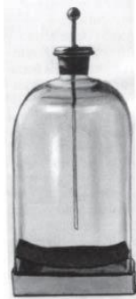
Чутливий електроскоп із соломинками, який використовував у своїх дослідках Алессандро Вольта (1781)
