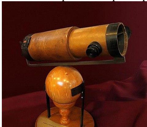
Телескоп-рефлектор Ньютона, представлений Королівському товариству в 1672 р.
