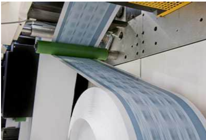
Рис. 6.51. Виготовлення електрохромних екранів струменевим друком рулонами [38]
