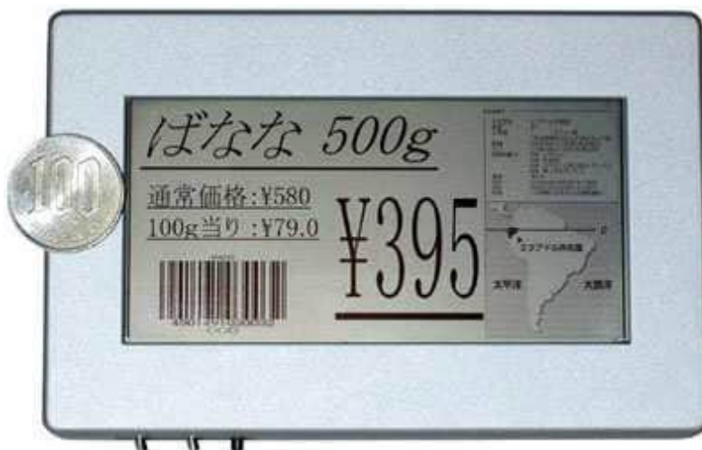
Рис. 6.32. Електронний цінник Citizen з використанням ChLCD -панелі [38]
