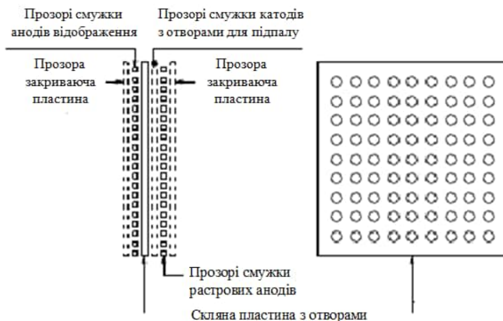
Рис. 6.19. Схема плазмової панелі [9]
