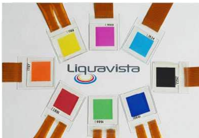
Рис. 6.57. Спектр можливих кольорів EW -екранів у стані «вимкнуто» [49]
