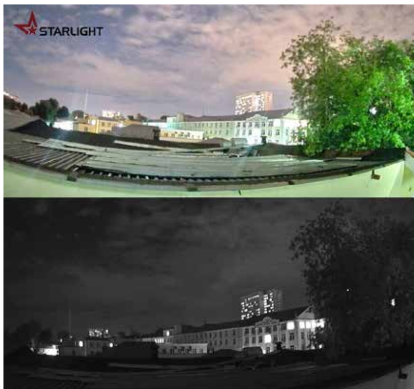
Рис. 3.8. Нічні зображення з відеокамери за технологією Starlight та відеокамери з ІЧ підсвічуванням
