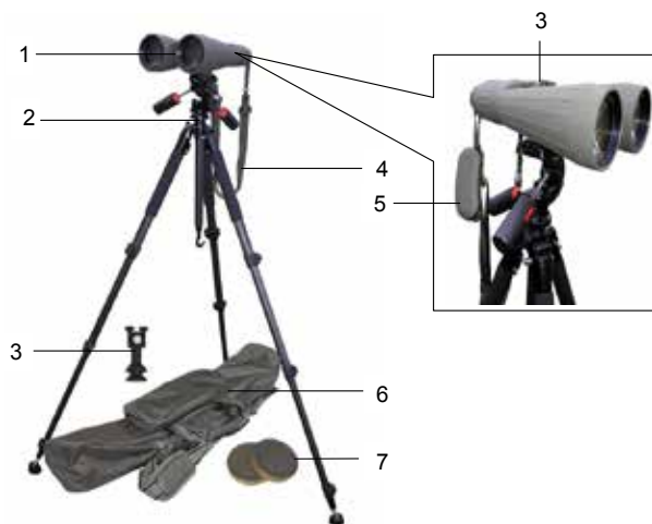
Рис. 2.24. Склад комплекту Steiner Military 20x80: 1 – бінокль; 2 – штатив; 3 – адаптер (2 шт.); 4 – нашийний ремінець; 5 – кришка окуляра; 6 – чохол; 7 – кришка об'єктива
