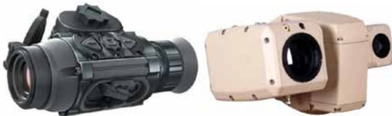
Рис. 3.39. Тепловізійні системи спостереження
