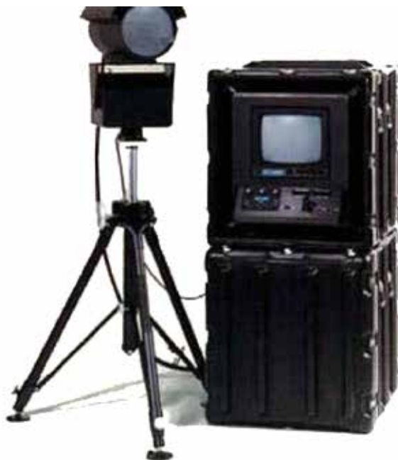
Рис. 3.30. Тепловізійна система першого покоління LORIS виробництва FLIR Inc
