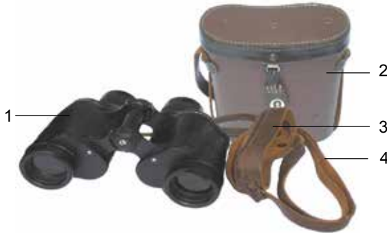
Рис. 2.22. Склад комплекту бінокля Б8Мх30:
