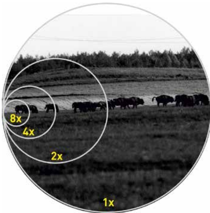
Рис. 3.17. Поле зору ПНБ залежно від його збільшення
