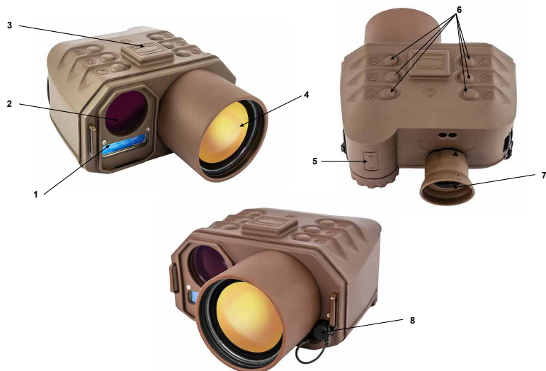
Рис. 3.45. Загальна будова переносного тепловізора NYXUS BIRD:
