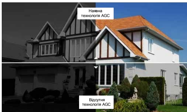
Рис. 3.6. Зображення з відеокамер з технологією AGC та без неї
