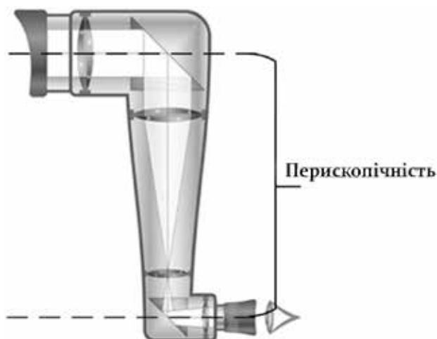
Рис. 2.15. Схема перископічного приладу
