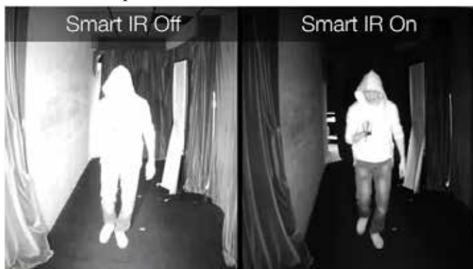
Рис. 3.7. Зображення з відеокамер з неактивованою та активованою функцією Smart IR
