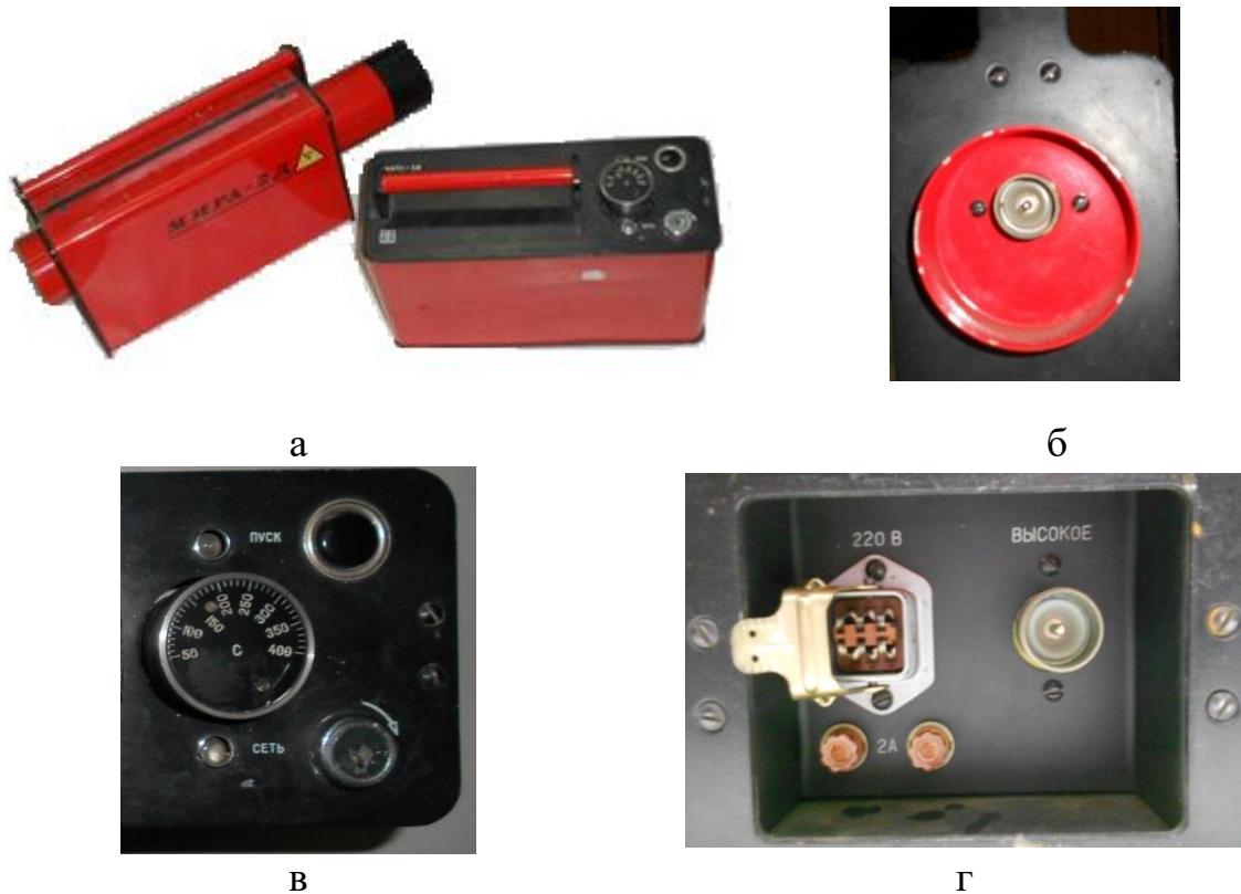
Рис 3.15. Рентгенівський апарат для проведення дефектоскопії «МИРА-2Д»: загальний вигляд (а); зворотна панель рентгенівського блоку (б); фронтальна (в) та зворотна (г) панелі блоку керування
