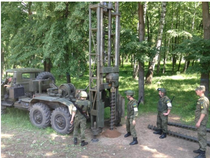
Рис.10.1. Пересувна бурова установка ПБУ-50
