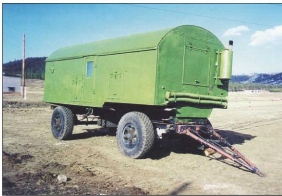
Рис.11.4. Військова силова електростанція ЕСД-100-Т/400 на шасі причепа 2-ПН-6
