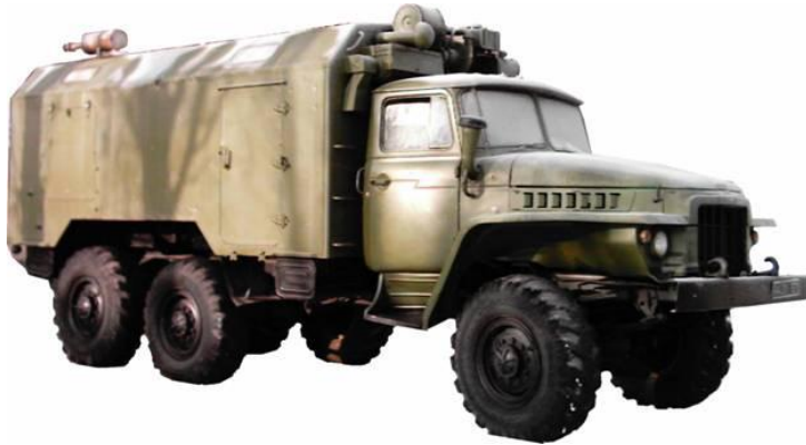
Рис.11.3. Військова освітлювальна електростанція ЕД-16-Т/230-1РАО в кузові-фургоні К1.4320
