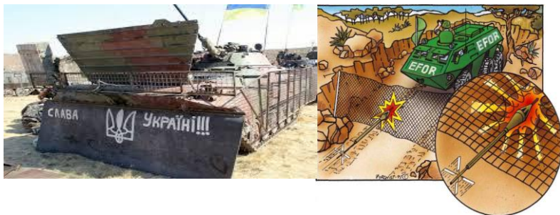
Рис. 2.68. Металева сітка для захисту від ураження гранатометами бойової техніки.
