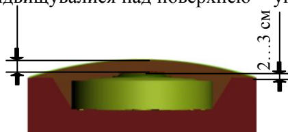
Рис.5.6. Установлення протитанкової міни вручну у твердий ґрунт
