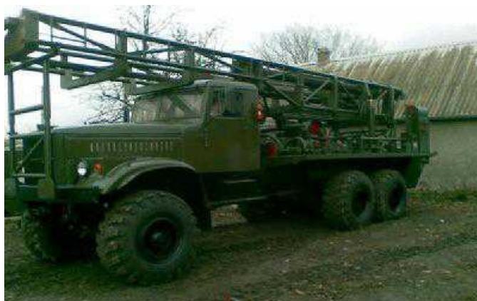
Рис.10.2. Пересувна бурова установка ПБУ-200
