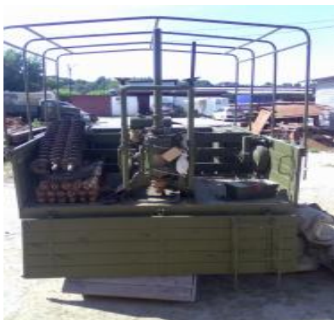
Рис.10.5. Установка добування води УДВ-15
