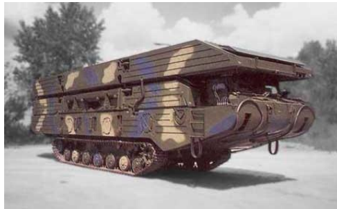
Рис.8.9. Самохідний паром ПММ-2М
