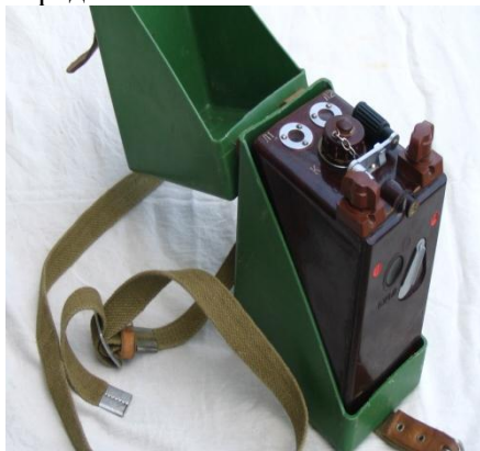
Рис.7.43. Підбивна машинка КПМ-3
