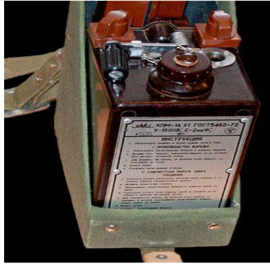
Рис.7.44. Підривна машинка КРМ-1А
