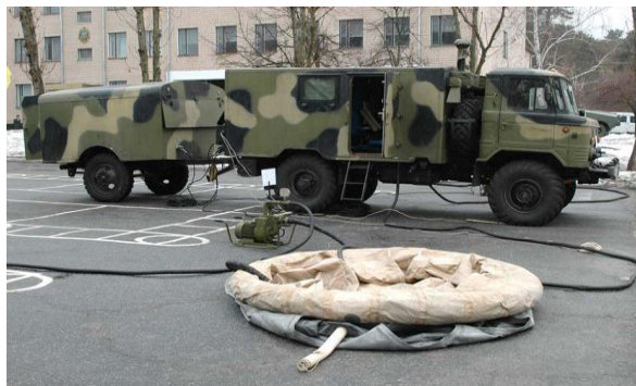
Рис.10.10. Військова фільтрувальна станція ВФС-2,5
