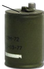
Рис.5.13. Протипіхотна міна ОЗМ-72
