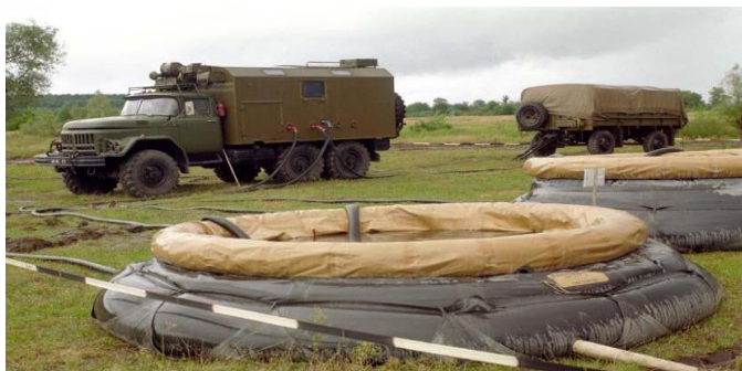
Рис.10.12. Військова фільтрувальна станція ВФС-10
