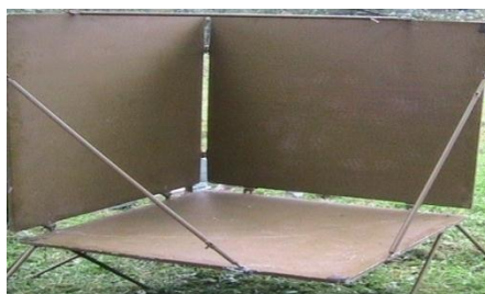
Рис.3.35. Кутовий відбивач „Угол”
