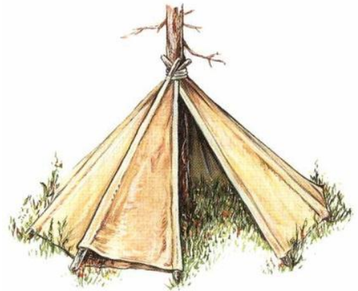
Рис. 6.7. Курінь з тентів навколо стовбура дерева
