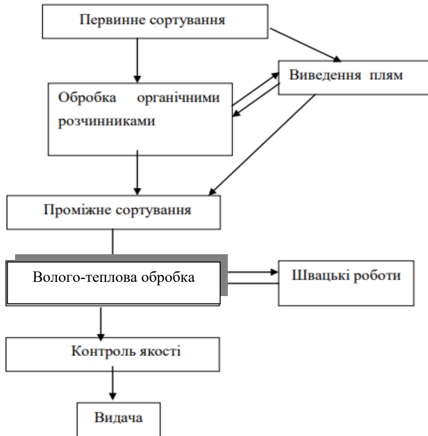
Рисунок 14.9 – Технологічна схема обробки виробів методом «сухого» чищення на підприємствах хімічного чищення
