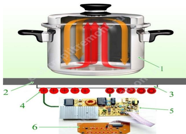
Рисунок 6.3 – Електроконтактне нагрівання: 1 – посуд; 2 – настил; 3–6 – електричний пристрій
