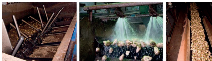
Рис. 315. Миття коренеплодів та обдування повітрям
