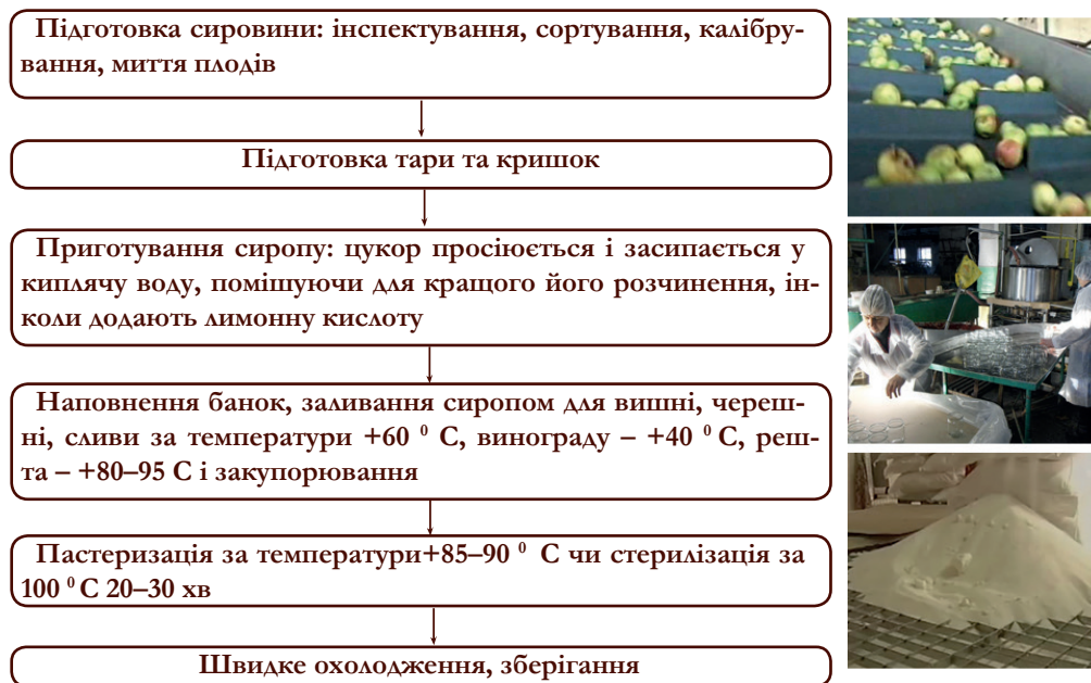
Рис. 262. Технологічна схема виробництва компотів
