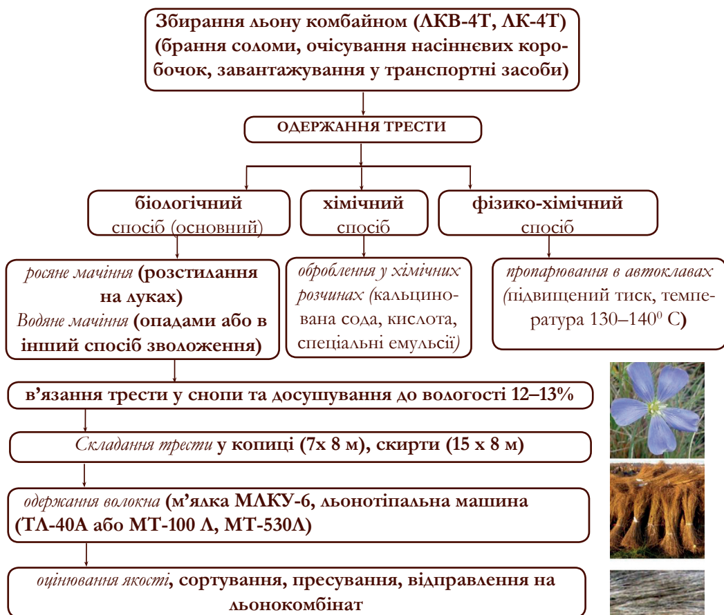
Рис. 334. Технологічна схема виробництва льоноволокна
