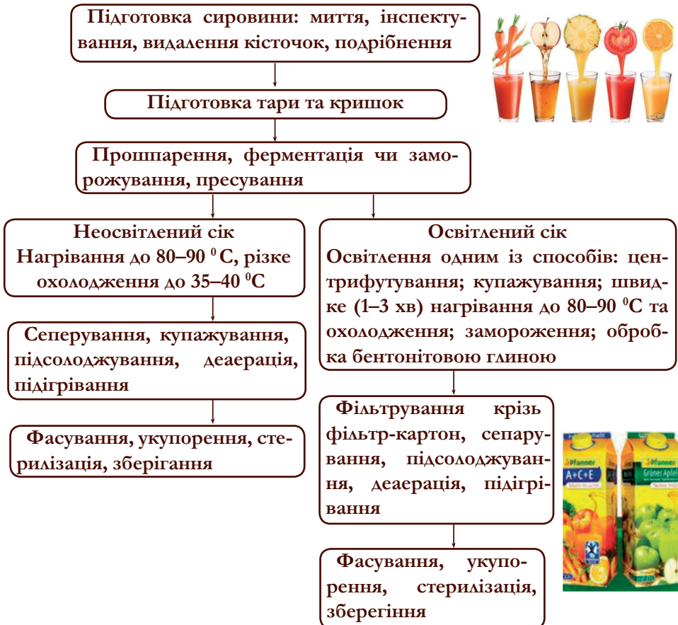
Рис. 268. Технологічна схема виробництва освітленого та неосвітленого соків
