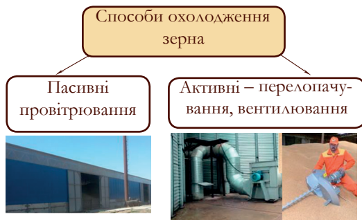
Рис. 47. Способи охолодження зерна
