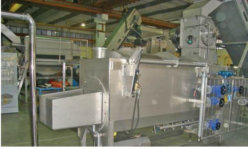
Рис. 208. Бланшувач з обертальним змійовиком Н51/11-50
