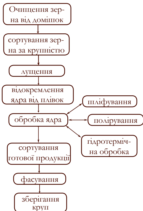
Рис. 72. Технологічна схема виробництва круп
