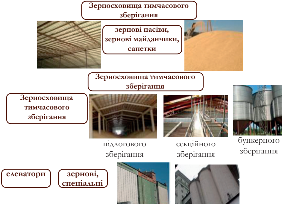
Рис. 50. Класифікація зерносховищ за періодом зберігання
