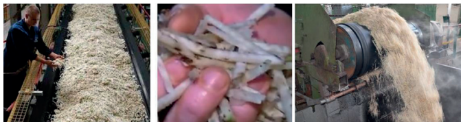
Рис. 316. Подрібнення буряків до стружки і обезсолоджування
