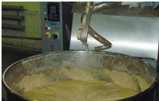
Рис. 79. Приготування тіста в тістомісильній машині
