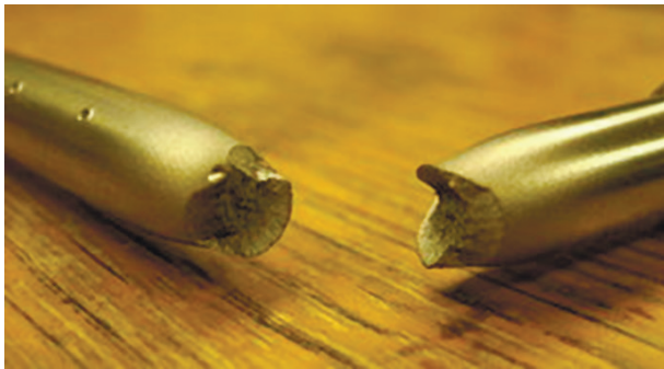
Рис. 1.15. Приклад в'язкого руйнування в умовах розтягу
