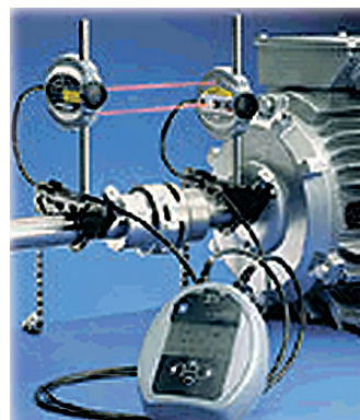
Рис. 2.13. Вимір неспіввісності валів за допомогою лазерної системи
