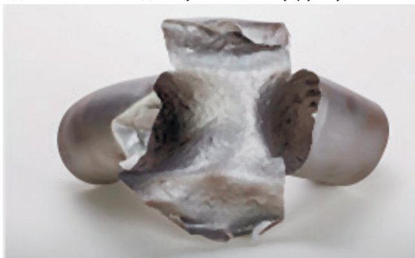
Рис. 1.26. Руйнування паропроводу в результаті корозійної ерозії
