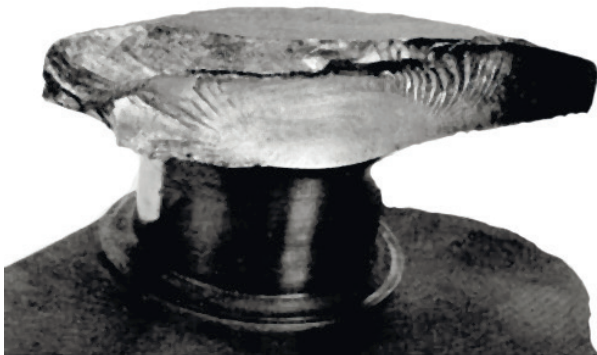
Рис. 1.18. Руйнування від втоми щоки колінчастого вала. Нижня зона зламу: втомне руйнування; верхня зона: зона крихкого доламу
