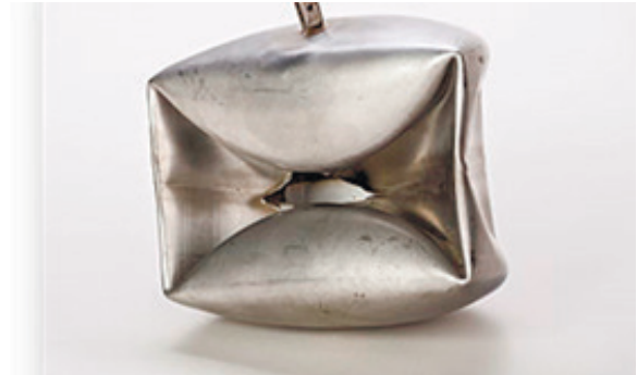
Рис. 1.22. Руйнування поплавця від втрати конструктивної стійкості під дією зовнішнього тиску
