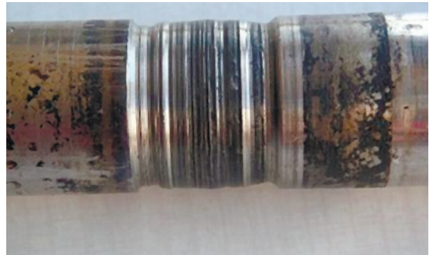
Рис. 1.23. Руйнування поверхні деталі від абразивного зношення
