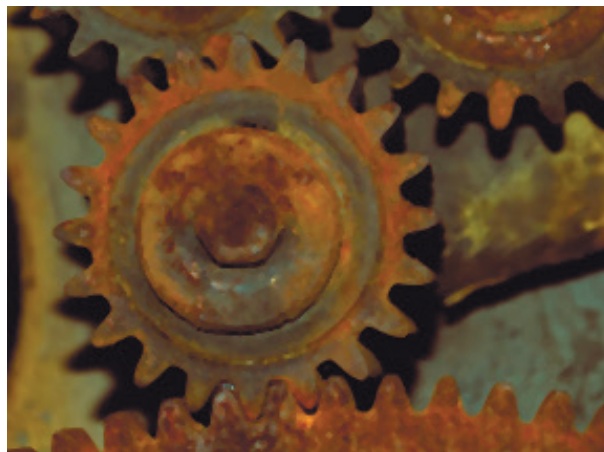
Рис. 1.27. Корозія на зубчастому зачепленні
