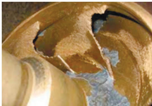
Рис. 1.29. Кавітаційне зношування робочого колеса насоса
