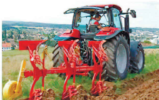
Плуги оборотні з системою «Onland» запобігають ущільненню ґрунту в підорному шарі
