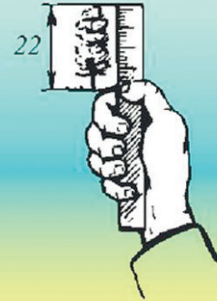
Рис. 2. Вимірювання вертикального і горизонтального кутів за допомогою лінійки Рис. 1. Вимірювання кута біноклем
