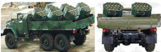
Універсальний мінний загороджувач УМЗ
