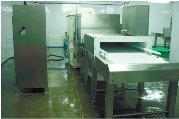
Рис. 4.24. Мікрохвильовий дефростер AMW 600 в роботі: 1 – апарат перед початком роботи; 2 – продукт перед завантаженням на розморожування; 3 – продукт після розморожування
