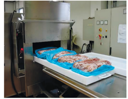
Рис. 4.24. Мікрохвильовий дефростер AMW 600 в роботі: 1 – апарат перед початком роботи; 2 – продукт перед завантаженням на розморожування; 3 – продукт після розморожування
