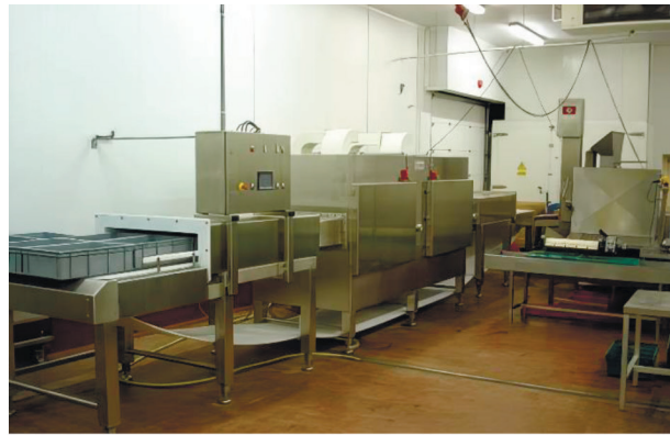
Рис. 4.24. Мікрохвильовий дефростер AMW 600 в роботі: 1 – апарат перед початком роботи; 2 – продукт перед завантаженням на розморожування; 3 – продукт після розморожування
