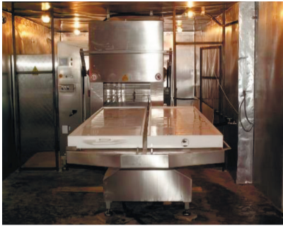
Рис. 4.24. Мікрохвильовий дефростер AMW 600 в роботі: 1 – апарат перед початком роботи; 2 – продукт перед завантаженням на розморожування; 3 – продукт після розморожування
