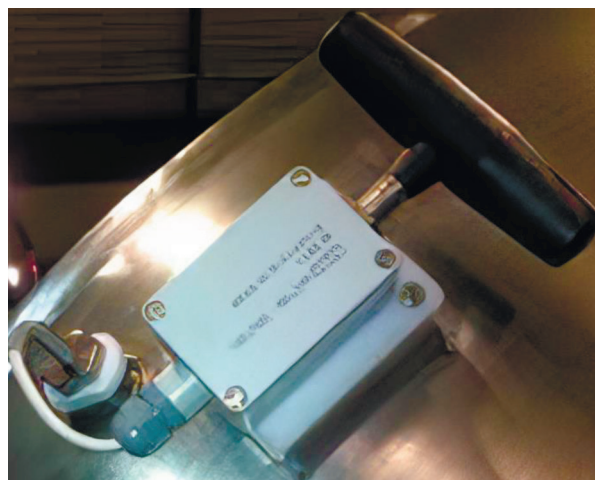
Рис. 4.9. Радіочастотний зонд для повного контролю температури продукту
