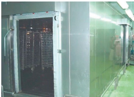
Рис. 4.5. Камера дефростації серії VGKL: а – зовнішній вигляд; б – вигляд візків всередині камери
