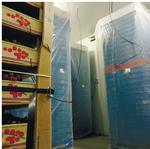
Рис. 5.5. Мішки з контрольованою системою компанії Van Amerongen
