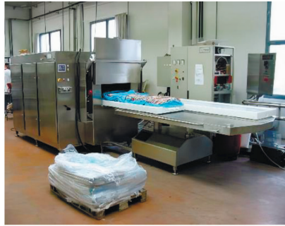
Рис. 4.24. Мікрохвильовий дефростер AMW 600 в роботі: 1 – апарат перед початком роботи; 2 – продукт перед завантаженням на розморожування; 3 – продукт після розморожування
