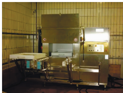
Рис. 4.23. Мікрохвильовий дефростер AMW 200 в роботі: 1 – апарат перед початком роботи; 2 – продукт перед завантаженням на розморожування; 3 – продукт після розморожування
