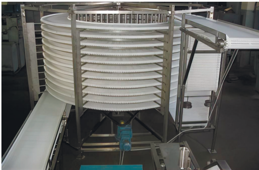
Рис. 3.15. Зовнішній вигляд змонтованої стрічки конвеєра спірального швидкоморозильного апарату
