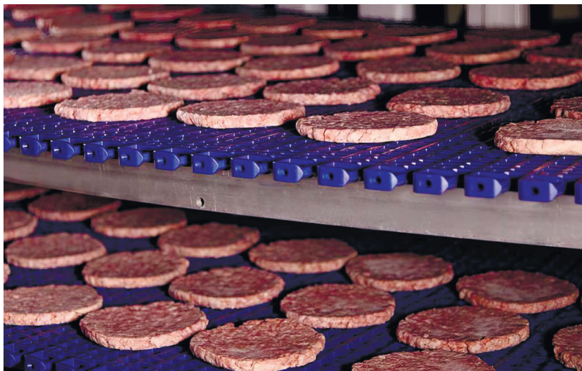
Рис. 3.16. Розташування м'ясних напівфабрикатів на полімерній стрічці конвеєра спірального морозильного апарата
