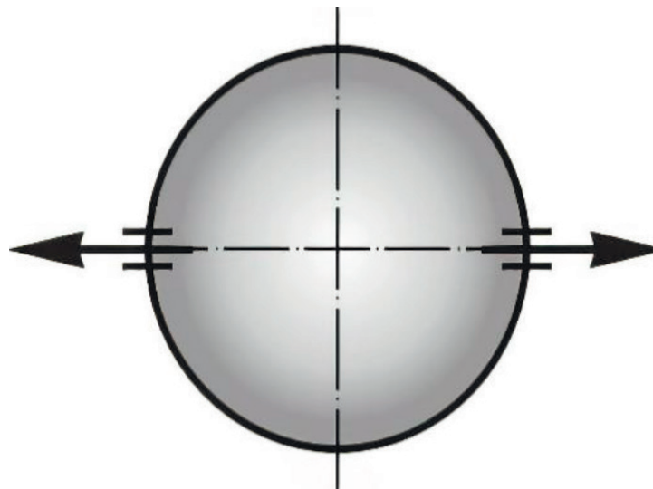
Рис. 1.12. Розподіл повітря через щілинний текстильний повітропровід
