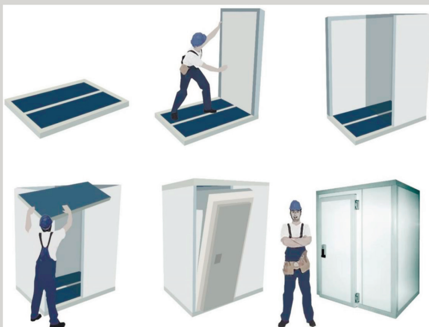
Рис. 6.8. Монтаж збірної холодильної камери
