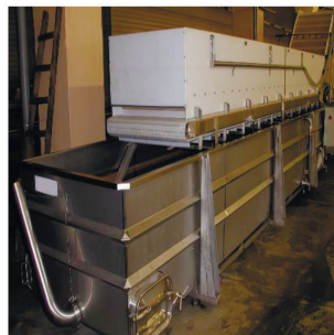
Рис. 4.15. Установка для размораживания пищевых продуктов в воде шляхом зрошення:
