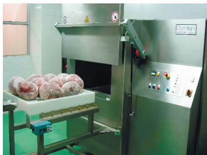
Рис. 4.23. Мікрохвильовий дефростер AMW 200 в роботі: 1 – апарат перед початком роботи; 2 – продукт перед завантаженням на розморожування; 3 – продукт після розморожування
