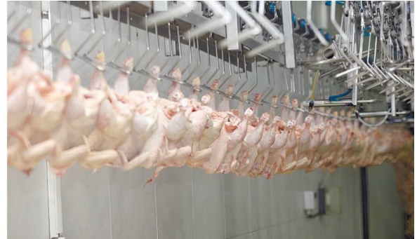
Рис. 2.51. Апарат для охолодження птиці зрошенням:
