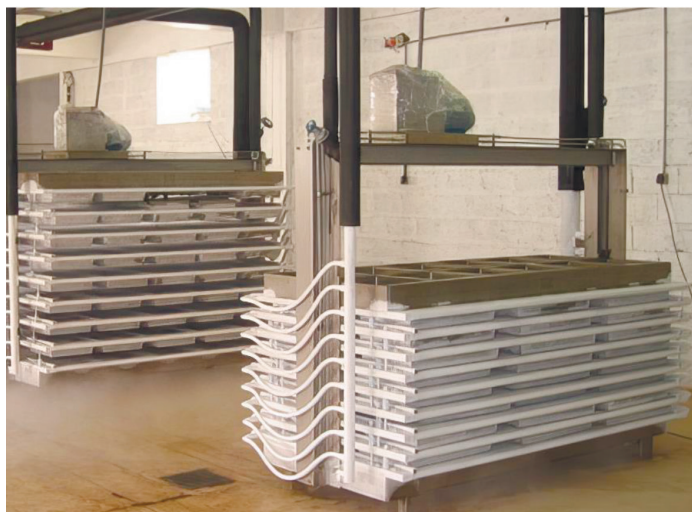
Рис. 3.28. Горизонтально-плиткові морозильні апарати фірми Tusal S.L. без теплоізолюваного контуру в роботі
