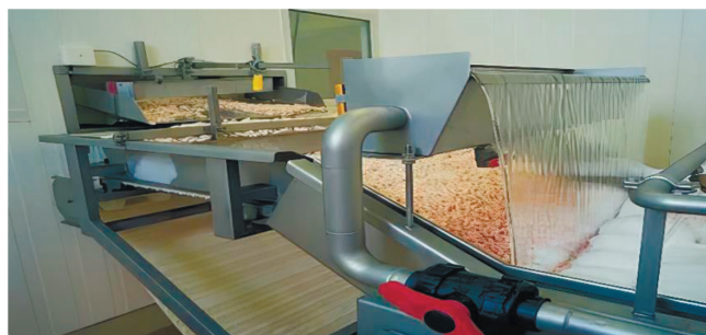
Рис. 4.13. Установка для розморожування продуктів зануренням у воду:
