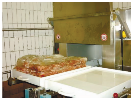
Рис. 4.23. Мікрохвильовий дефростер AMW 200 в роботі: 1 – апарат перед початком роботи; 2 – продукт перед завантаженням на розморожування; 3 – продукт після розморожування
