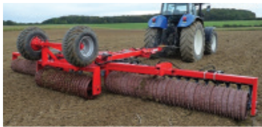
Рис. 116. Ущільнення ґрунту коткуванням
