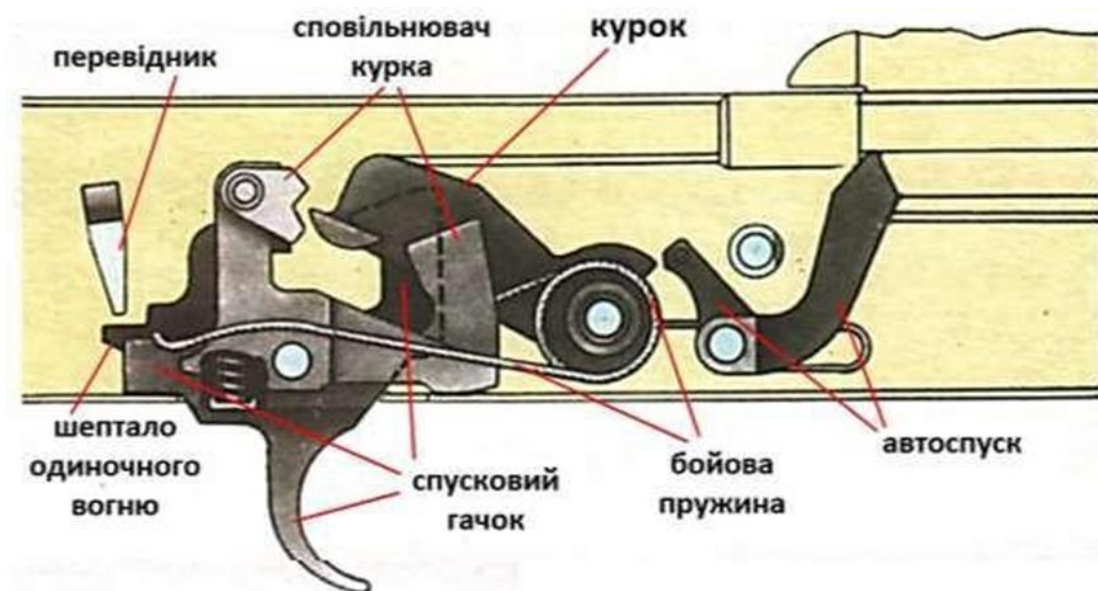
Рис. 6.48. Положення частин ударно-спускового механізму після заряджання, коли перевідник встановлений на автоматичний вогонь
