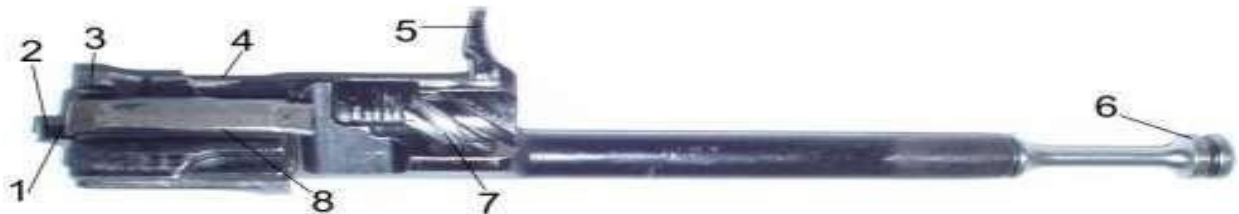
Рис. 6.18. Затворна рама з газовим поршнем:
