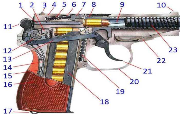
Рис. 5.20. 9 мм пістолет Макарова у розрізі:
