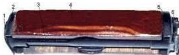
Рис. 6.20. Газова трубка зі ствольною накладкою:
