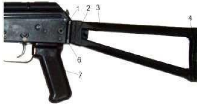
Рис. 6.13. Приклад (відкинуте положення) і пістолетна рукоятка:
