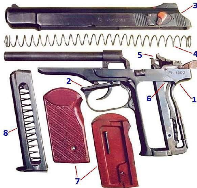
Рис. 5.29. Основні частини 9 мм пістолета Стєчкіна
