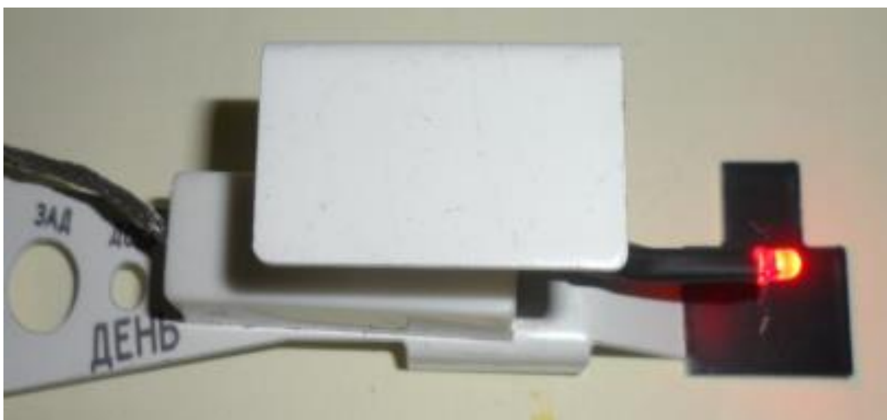
Рис. 8.13 б. Імітатор вогню закріплений на указці магнітній
