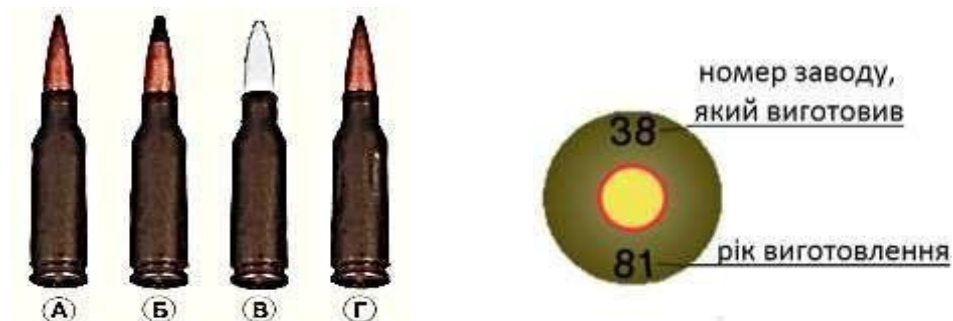
Рис. 4.3. Різновидності та маркування автоматного патрона 5,45х39 мм: А – із звичайною кулею (зі сталевим чи свинцевим осердям); Б – з трасуючою кулею; В – холостий (пластикові куля); Г – навчальний
