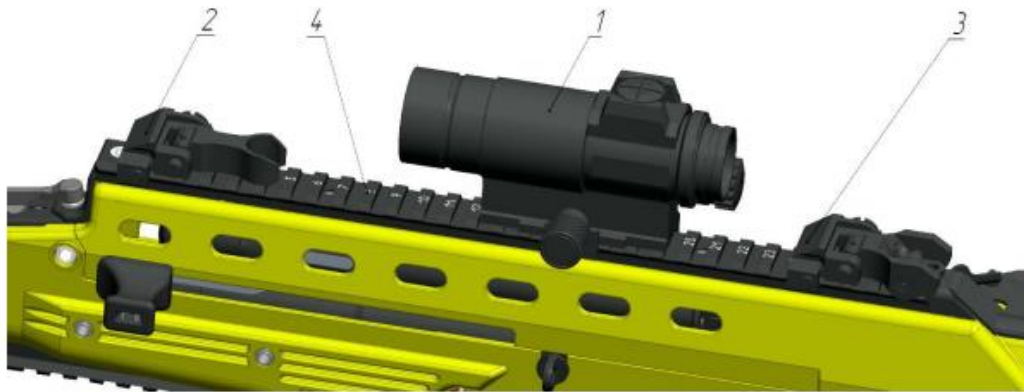
Рис. 6.93. Встановлення механічних і оптичних прицілів 1 – коліматорний приціл; 2 – механічна мушка; 3 – механічний приціл; 4 – верхня планка «пикатінні»
