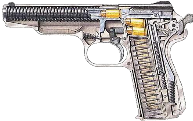
Рис. 5.30. Зібраний 9 мм пістолет Стечкина в розрізі
