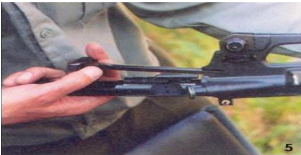
Рис. 6.66. Вилучення стебла затвора та планки перезарядження.
