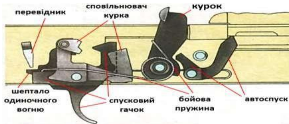
Рис. 6.44. Положення частин ударно-спускового механізму до заряджання, коли курок спущений та увімкнений запобіжник
