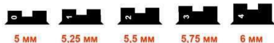
Рис.5.26. Набір ціликів пістолета Макарова, їх номери і висота
