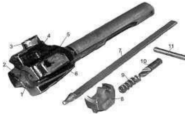
Рис. 6.19. Затвор (з ударником і викидачем):
