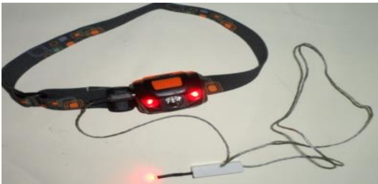
Рис. 8.13 а. Ліхтарик в ввімкненому стані з підключеним імітатором вогню
