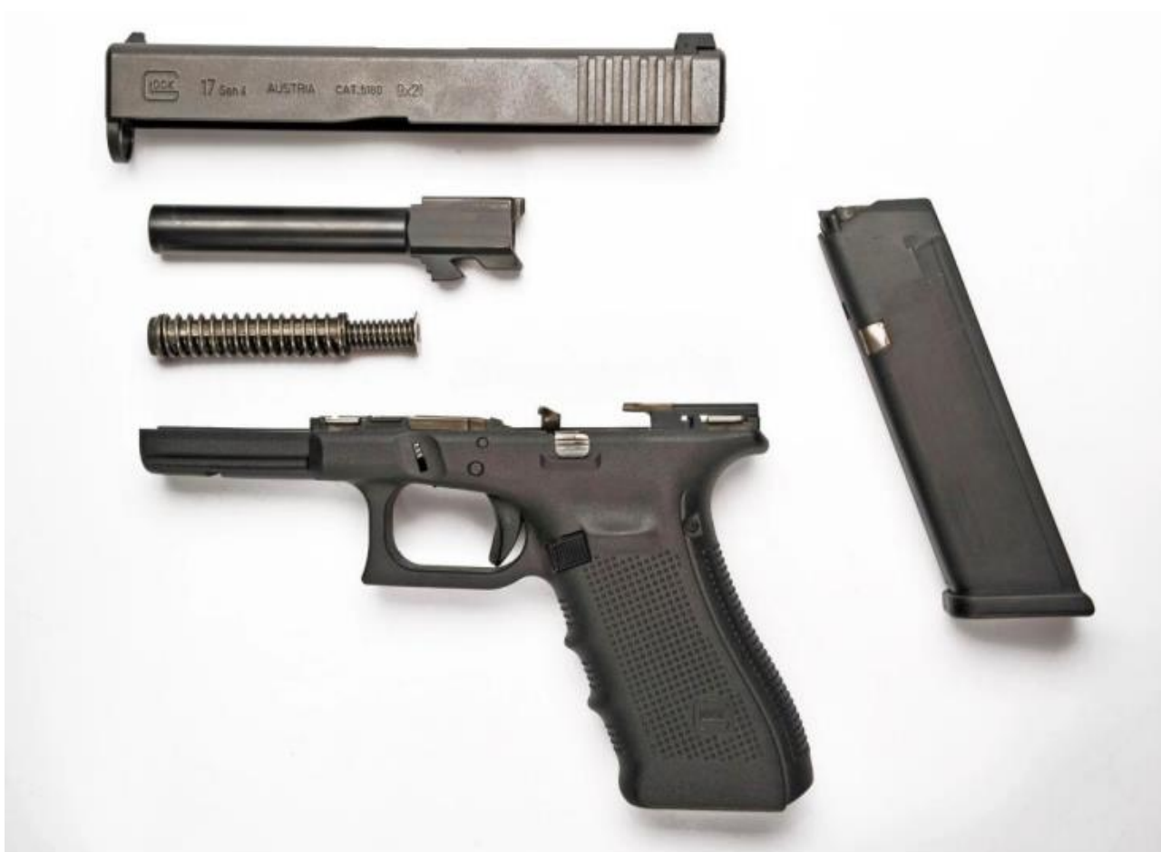
Рис. 5.32. Основні частини 9мм пістолета Glock 17
