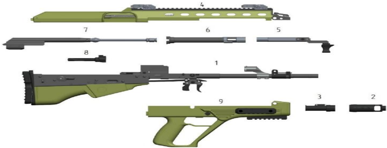
Рис. 6.69. Основні частини та механізми автомата
