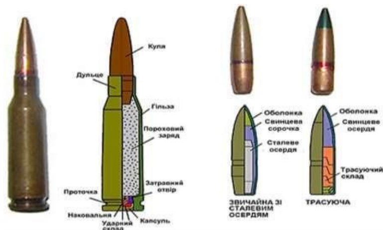
Рис. 4.4. Будова автоматного патрона 5,45х39 мм та його кулі: зі сталевим осердям і трасуючої
