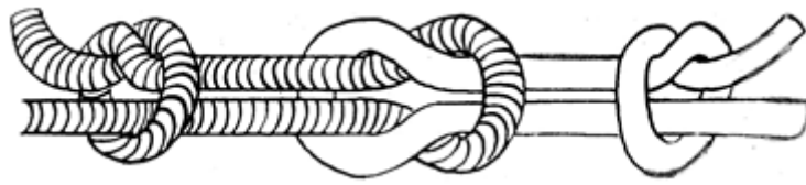
Рис. 4.8.3. Прямий вузол з контрольними вузлами
