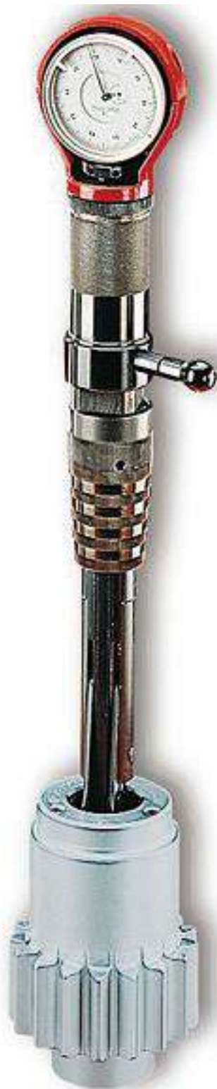
Рис. А.2 –Твердомір N6 призначений для вимірювання твердості внутрішніх циліндричних поверхонь за Роквеллом за шкалою HRC
