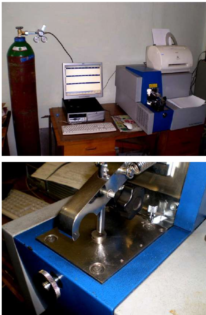
Рис. 3.9 – Стационарна установка для проведения спектрального анализа SPECTROMAXx
