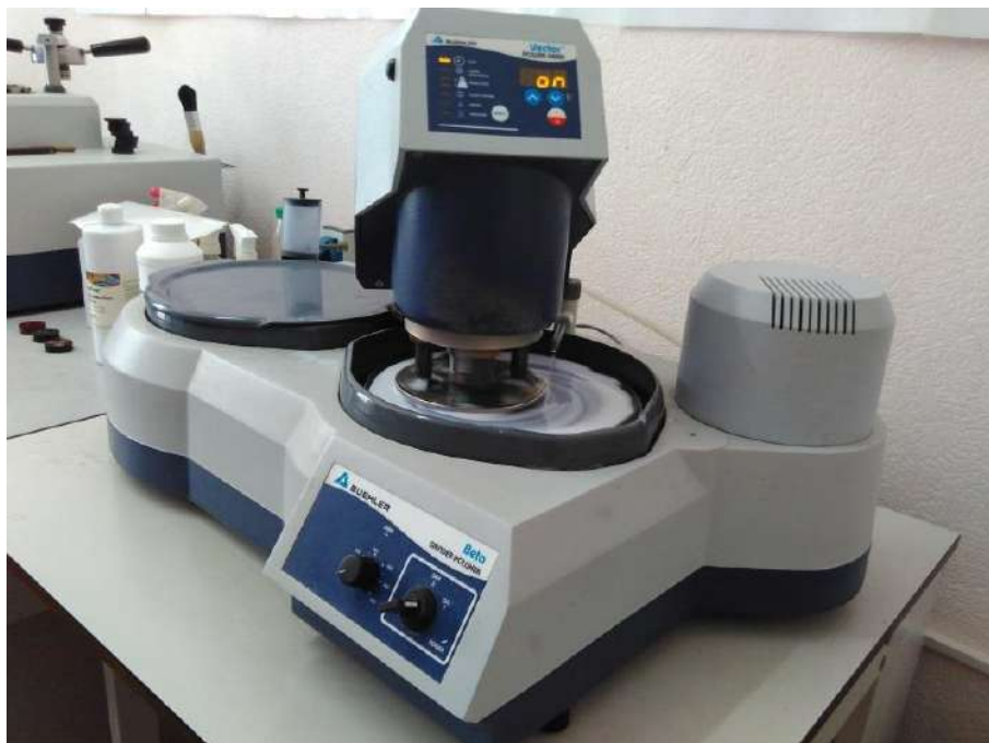
Рис. 3.4 – Установка для отримання металографічних шліфів Beta Grinder-Polisher
