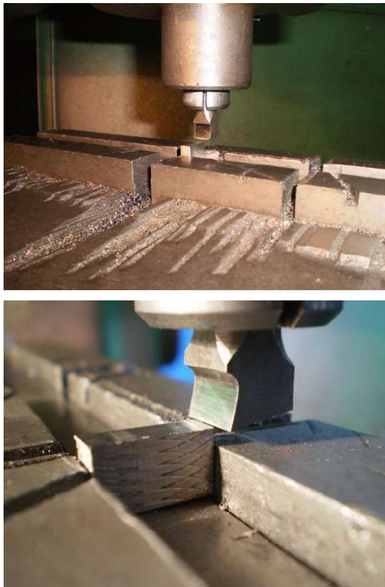
Рис. 3.15 – Процес вільного прямокутного різання
