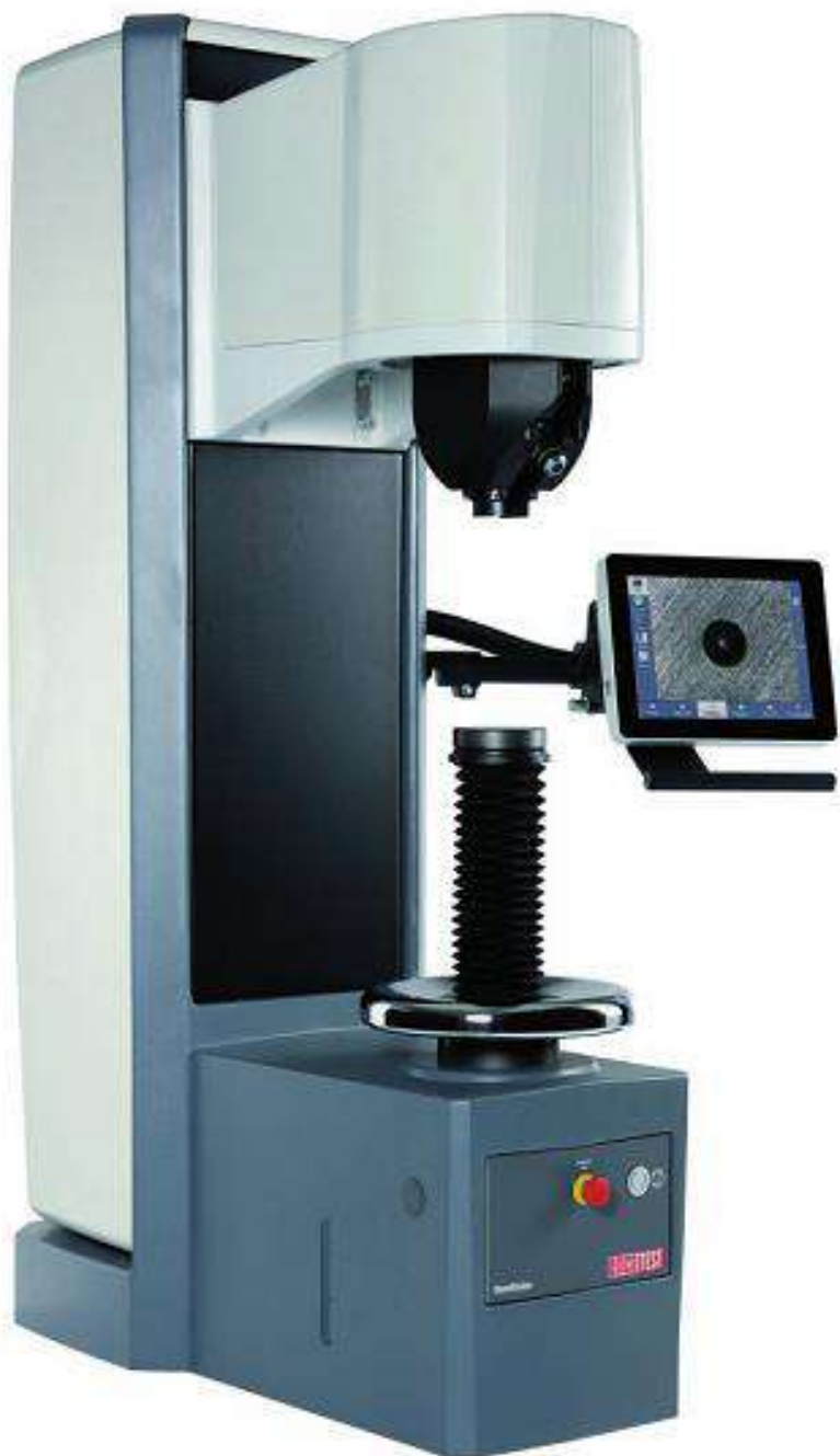
Рис. А.1 – Універсальний прилад Dura Vision-20 для вимірювання твердості: за Брінеллем, Роквеллом, Віккерсом
