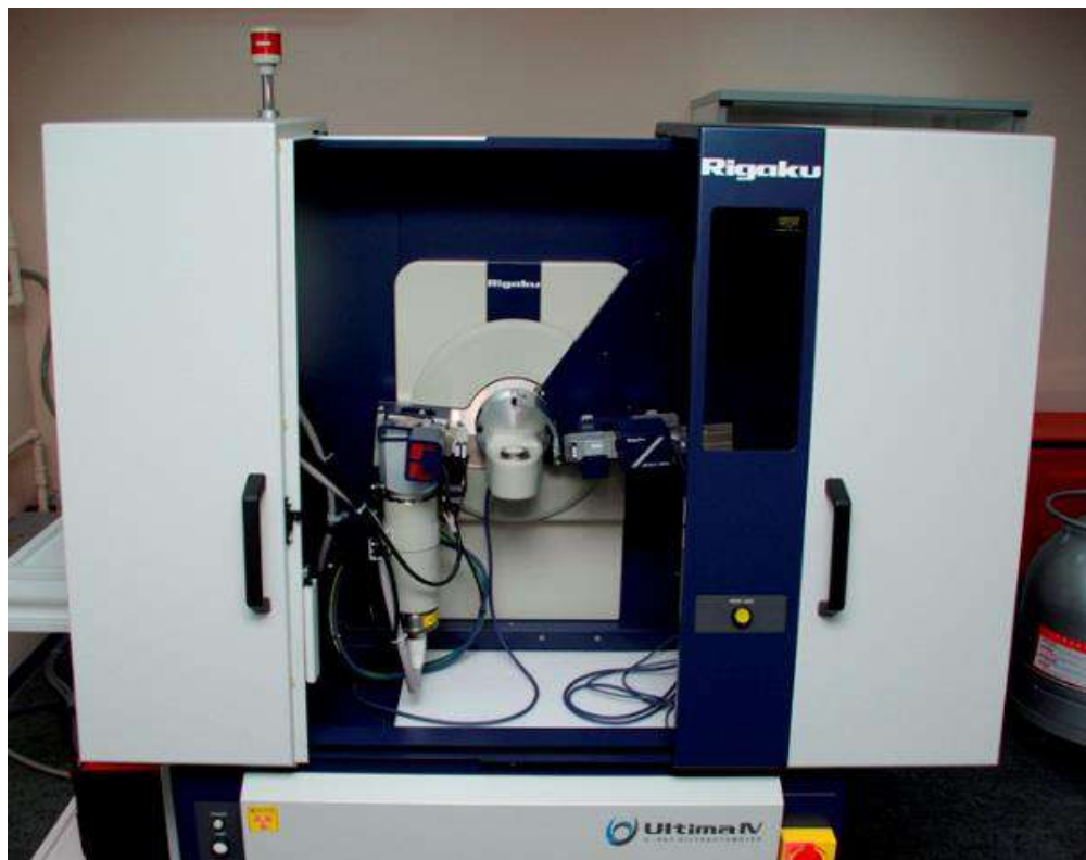
Рис. 3.12 – Рентгенівський дифрактометр Rigaku Ultima IV
