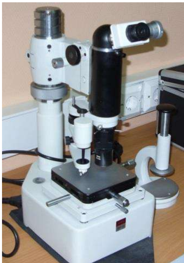
Рис. 3.3 – Прилад для вимірювання мікротвердості ПМТ–3
