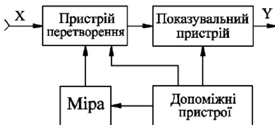
Рис. 14.3. Структурна схема аналогового вимірювального приладу, де X – вимірювана (вхідна) фізична величина, Y – показ приладу (результат вимірювання).
