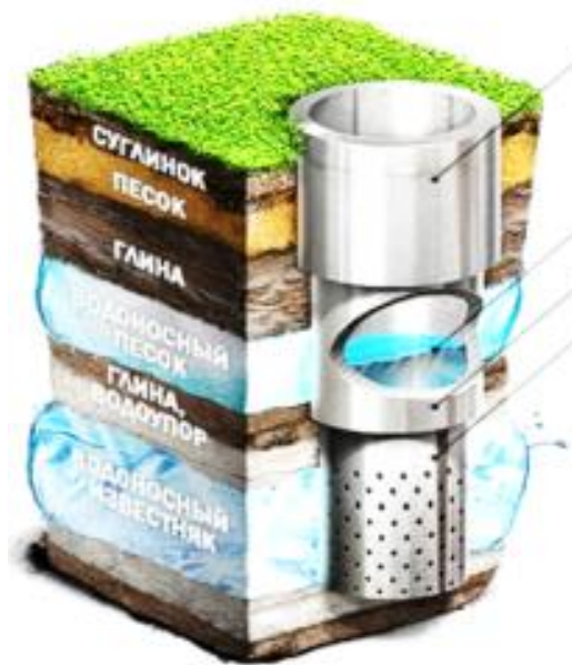
Рисунок 3.7 – Побудова бурового колодязю (позначення див. рис. 3.6)
