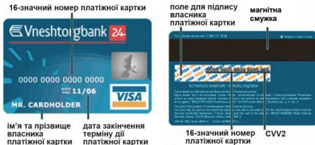
Рис. 2. Будова магнітної пластикової картки [76, с. 64]
