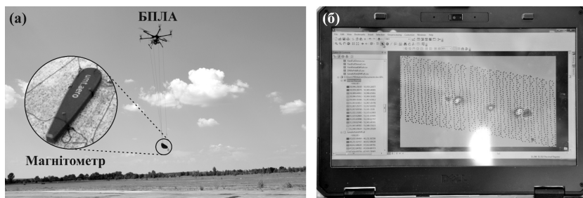
Рис. 95. БПЛА з магнітометром у процесі обстеження території (а) і візуалізація та обробка просторових даних вишукувань (б)
