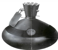
Рис. 16. Британська протитанкова міна АТМ (1928)
