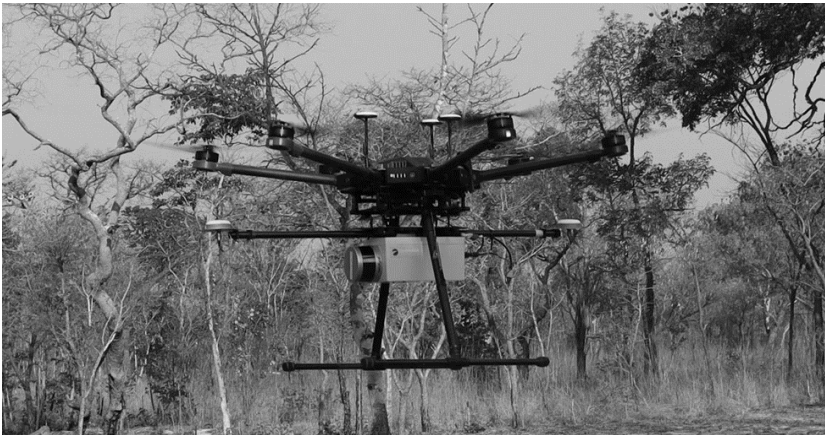
Рис. 71. LIDAR система БПЛА Routescene, встановлена під DJI M600 Pro в Анголі
