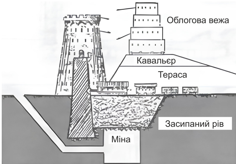
Рис. 1. Схема підкопу під облогову вежу
