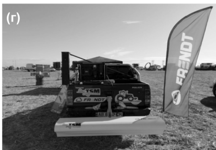
Рис. 67. в – сенсорна система Veris для вимірювання кислотності (pH), відсотка органічної речовини на глибині росту (0 – 30 см) і в кореневій зоні (0 – 90 см); г – Topsoil Mapper для визначення структури, вологозабезпеченості, ущільнення та оптимальної глибини розділення
