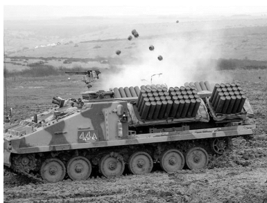
Рис. 25. Системи дистанційної доставки мін: a – Shielder; б – US M139 Volcano
