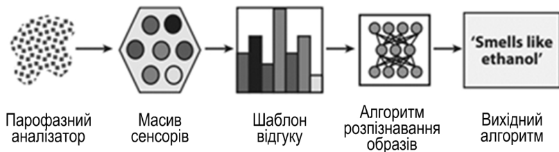
Рис. 73. Схема загальних компонентів штучного носа
