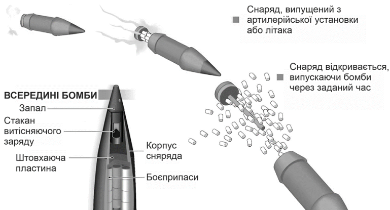
Рис. 26. Принцип роботи кластерної зброї
