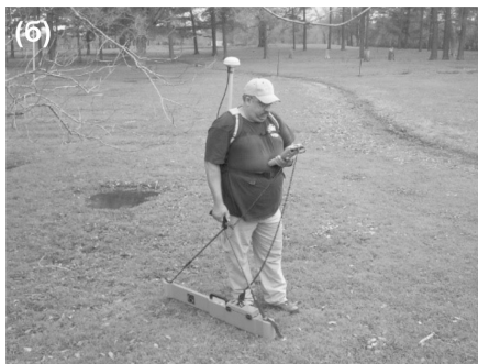
Рис. 67. а – SMTE датчик вологовмісту, температури та електропровідності ґрунту; б – Geonics EM-38 для вимірювання електромагнітної провідності ґрунту
