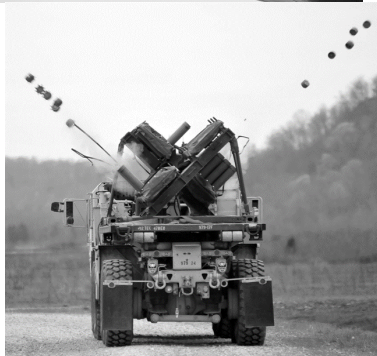
Рис. 25. Системи дистанційної доставки мін: a – Shielder; б – US M139 Volcano
