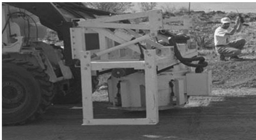
Рис. 78. Виявлення мін на основі нейтронів
