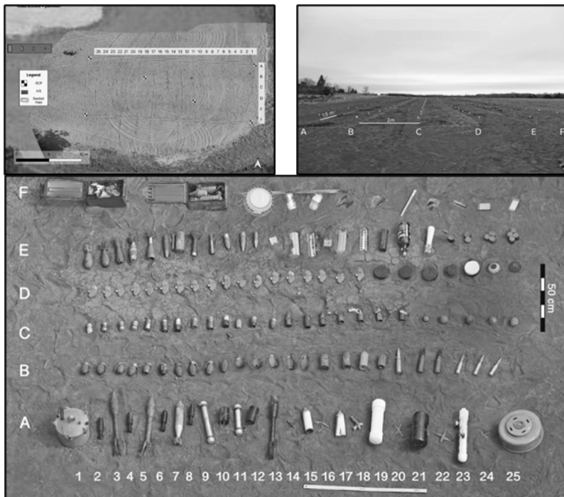
Рис. 94. Експериментальне поле, його точна фіксована розмітка та вибухонебезпечні об'єкти для розмінувальних тестувань
