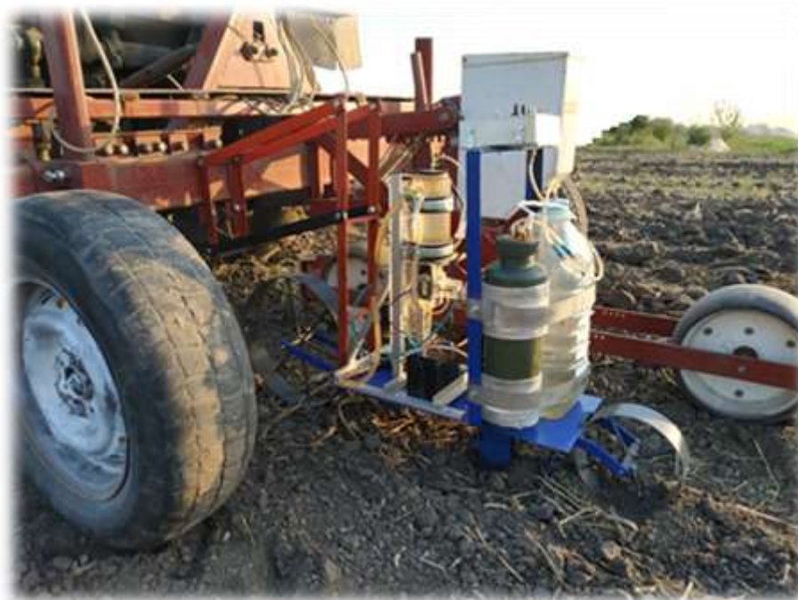
Рис.1. Експериментальна сівалка з гідропневматичним апаратом точного висіву пророслого насіння овочевих культур
