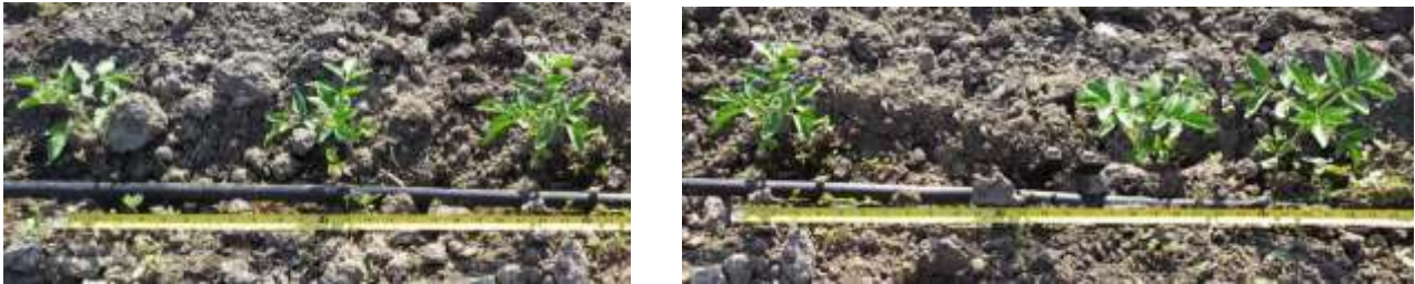
Рис. 3. Розподілення сходів томату «Астероїд» при сівбі посівною секцією: а) експериментальної сівалки; б) базової сівалки Клен-1,8
