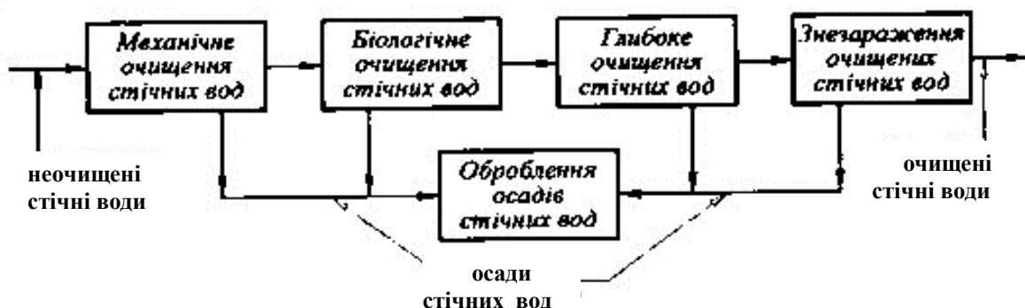
Рисунок 3.1 – Блок схема процесу очищення стічних вод
