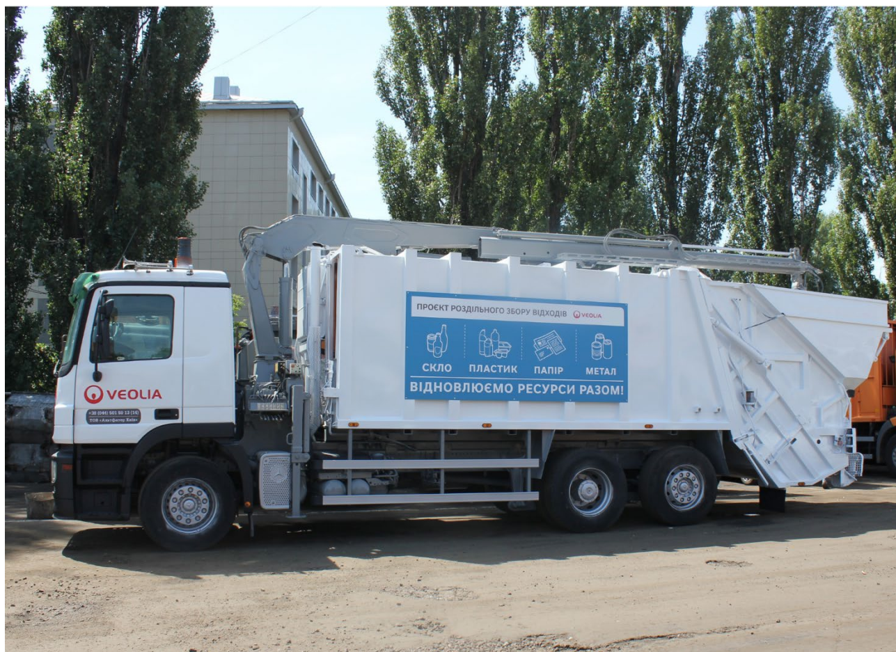
Транспортний засіб для перевезення роздільно зібраних відходів компанії Veolia із можливістю завантажувати контейнери із нижнім вивантаженням
