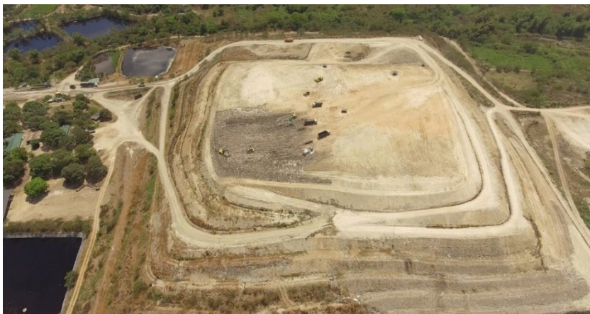
Видалення на полігоні коли відкрита лише невелика ділянка для захоронення (правильна експлуатація полігону) вплив на навколишнє середовище мінімальний
