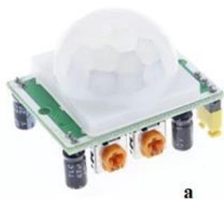
Рис.7. Датчик руху HC-SR501 (а), його призначені контакти та органи управління(б)
