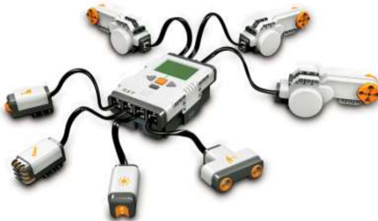
Рис. 2.6.2 Зовнішній вигляд керуючого блоку, двигунів та сенсорів LEGO Mindstorms NXT 2.0 [9]
