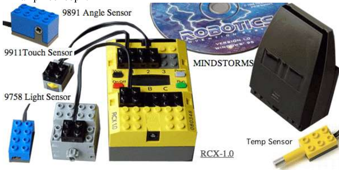
Рис. 2.6.1. Зовнішній вигляд LEGO Mindstorms RCX з двигунами та датчиками [8]
