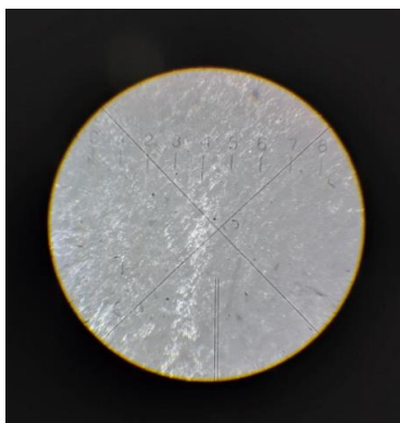
Рис.1. Поверхня Zn_{0.1}Cd_{0.9}Te до полірування.
