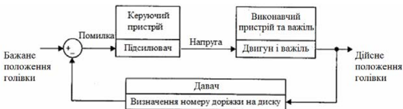
Рисунок 3.24 б) – Функціональна схема системи дисководу
