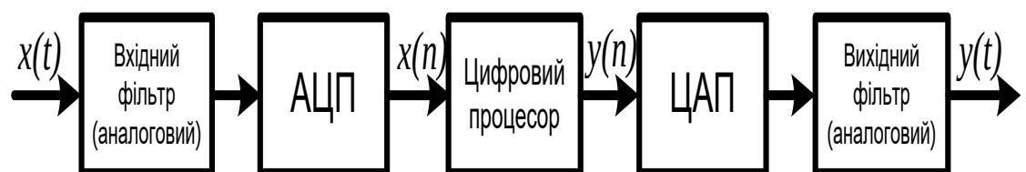
Рис. 3.1. Спрощена блок-схема ЦФ реального часу
