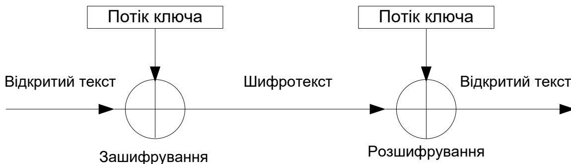
Рис. 15. Типова схема роботи потокового шифру
