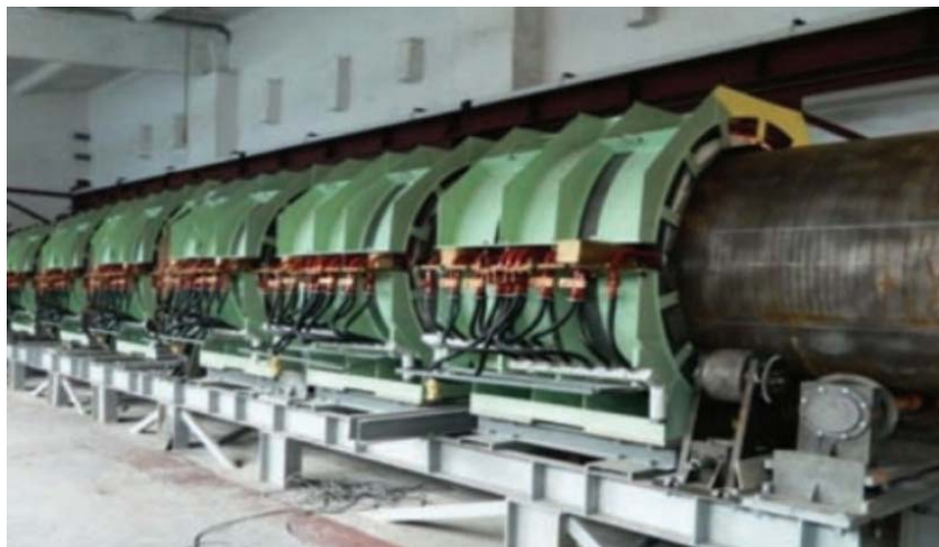
Рис. 80. Індукційна піч для термодифузії в електромагнітному полі (метод ТДСІ для формування захисних шарів на основі Zn, Cu, Al, Cr, Ni)
