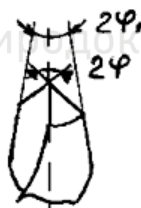
Рис. 114. Подвійне заточування свердла
