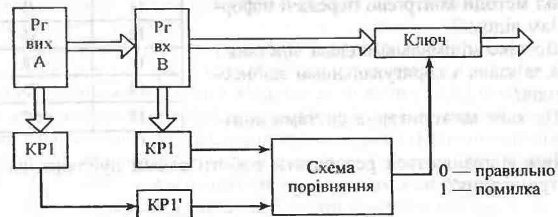
Рис. Л.1.5. Схема реалізації методу контролю паритетів
