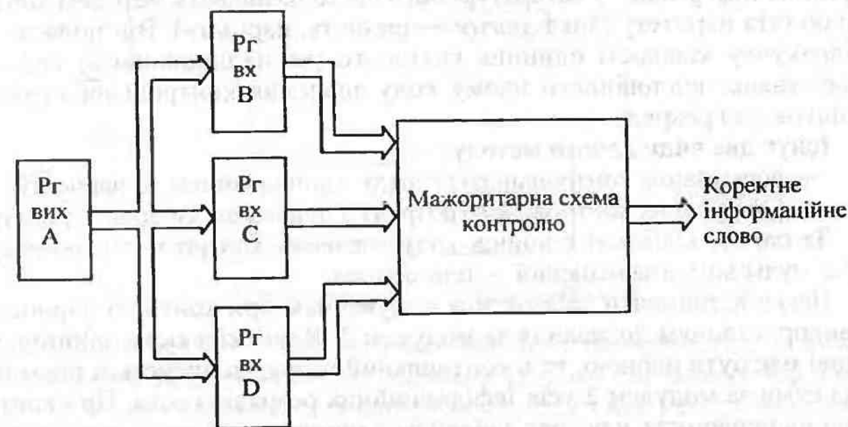
Рис. Л.1.2. Схема апаратної реалізації методу троювання
