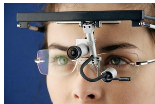
Рисунок 19.5 - Апаратна складова комплексу Eye tracking
