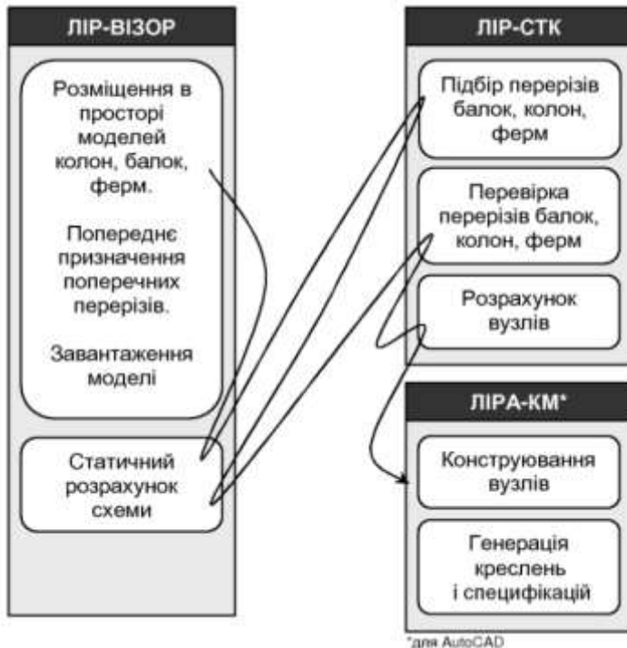
Рисунок 4.4.1 – Процес проєктування металевих конструкцій у ПК ЛІРА-САПР [12]
