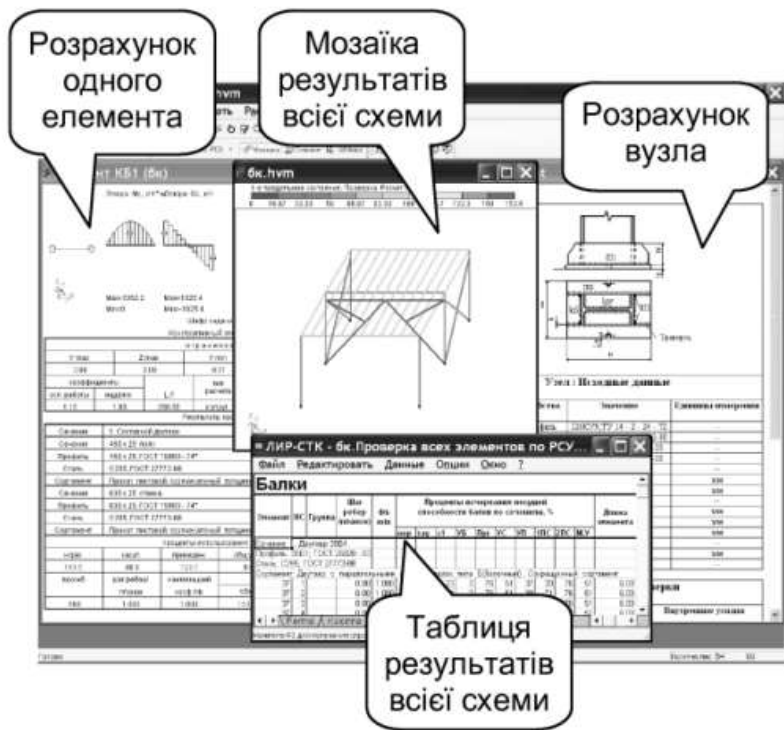
Рисунок 4.4.2 – Вигляд вікна підсистеми розрахунку металевих конструкцій СТК-САПР [12]
