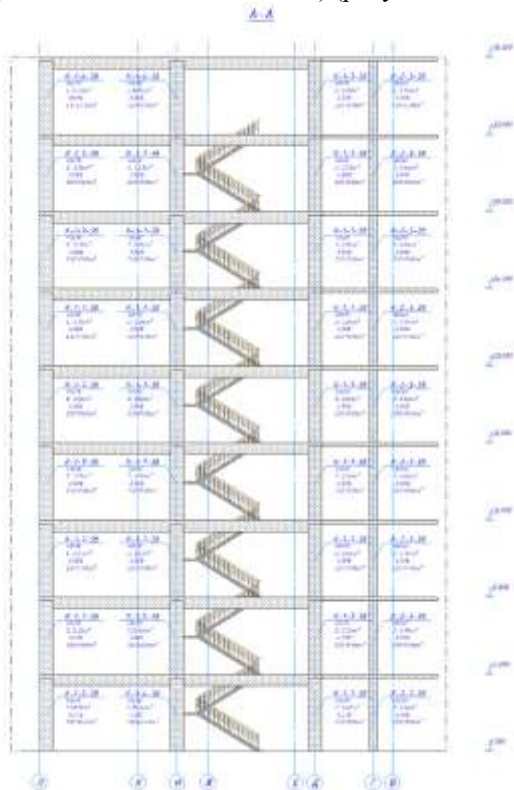
Рисунок 4.15.13 – Розріз з марками колон та інформацією про їх армування
