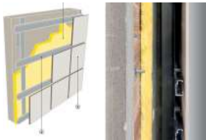
Рис.5.6.3. Функціональні шари вентфасаду
