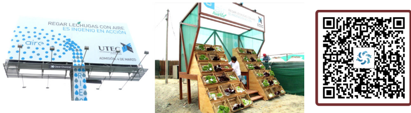
Рис. 1.38. Рекламний щит, який збирає воду і працює як міська ферма завдяки крапельному зрошуванню, Air Orchard – UTEC, Ліма, Перу, 2015 [518].
