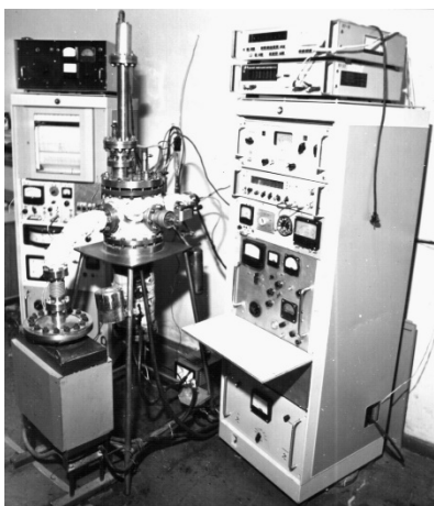
а) надвисоковакуумна установка для одержання наноплівки
