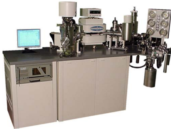
Рис. 8. Мас-спектрометр MI 1201 АГМ 01М (ВАТ «Selmi» 2010 р.) з безмасляною вакуумною системою попереднього відкачування
