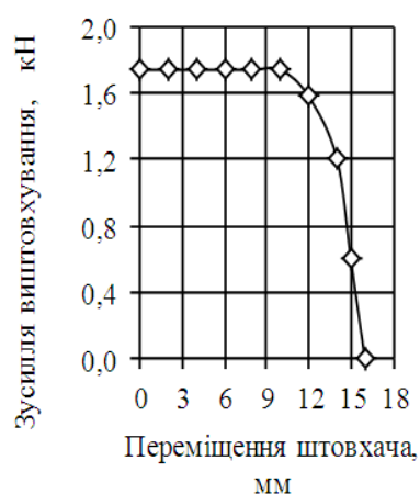
Рис. 6.12. Залежність зусилля виштовхування від переміщення штовхача
