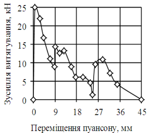
Рис. 6.15. Залежність зусилля витягування від переміщення пуансону
