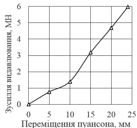
Рис. 6.37. Залежність зусилля видавлювання від переміщення пуансону
