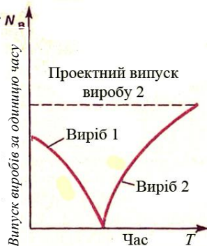
Рис. 1.3. Безперервно-послідовний метод переходу на випуск нового виробу
