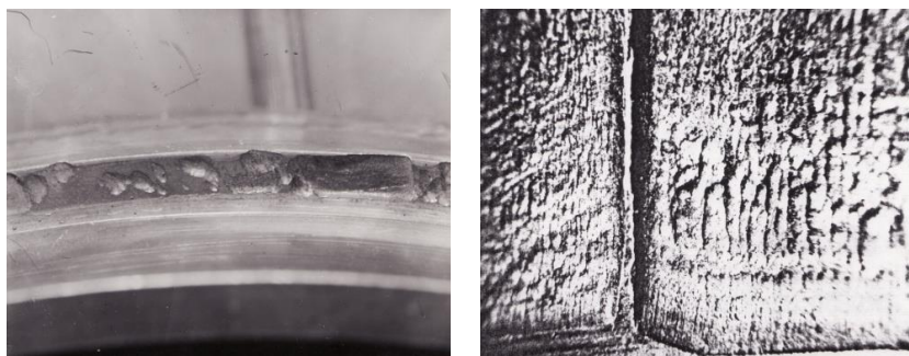
Рис. 5.14. Характер пошкодження поверхні деталей фретинг-корозією в умовах високих температур
