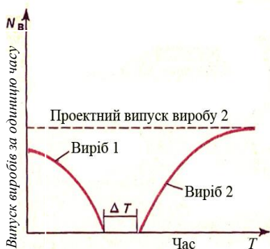
Рис. 1.2. Перервно-послідовний метод переходу на випуск нового виробу
