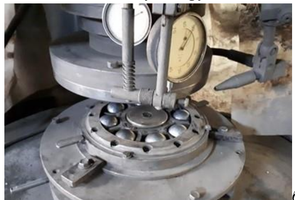
Рисунок 5.11 – Верстат мод. ВШ-Д204М ( а ) і розміщення керамічних заготовок при попередньому алмазному шліфуванні
