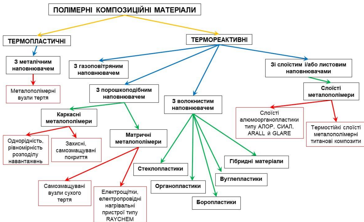
Рисунок 5.24 – Класифікація полімерних композиційних матеріалів
