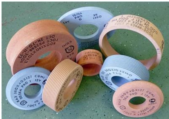
Рисунок 3.21 – Високоструктурні шліфувальні круги різного технологічного призначення
