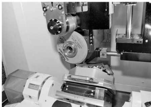
Рисунок 3.13 – 5-ти осьовий багатоопераційний ОЦ з поворотно-оберттовим столом з магазином інструментів для комплексної обробки лопаток:
