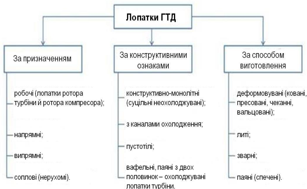
Рисунок 3.7 – Класифікація лопаток ГТД за призначенням
