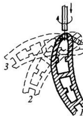
Рисунок 3.52 – Схема переміщення лопатки під час прошивання охолоджувальних отворів на входній кромці: 1...3 – положення лопатки відносно електрода при послідовному прошиванні отворів
