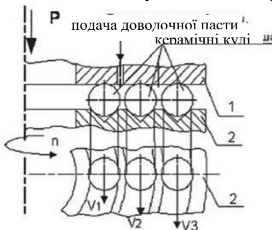
Рисунок 5.15 – Схема доведення куль між двома дисками
