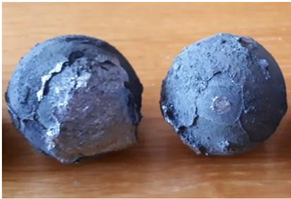
Рисунок 5.10 – Керамічні заготовки після спікання ( а ) й готові кулі з SiC ( б )
