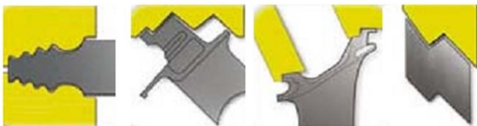
Рисунок 3.19 – профільне глибинне шліфування фасонних поверхонь турбінних лопаток
