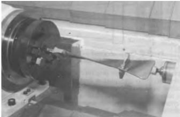
Рисунок 3.68 – Двостороння обробка лопатки на верстаті НХ-151
