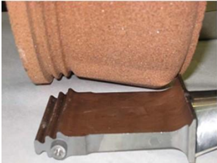
Рисунок 3.22 – Високоструктурний шліфувальний круг 1500×130×203,2 і оброблений хвостовик лопатки
