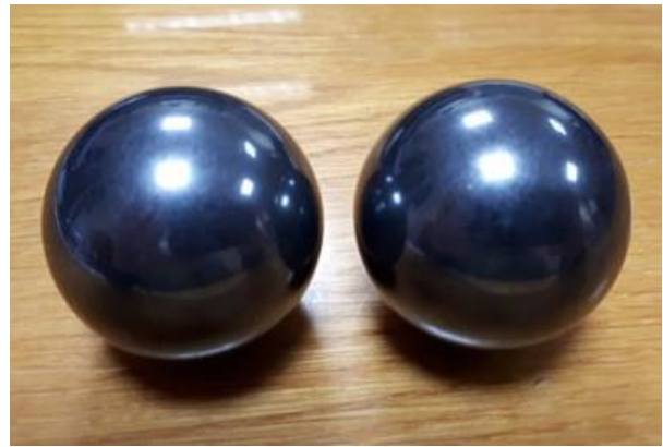
Рисунок 5.10 – Керамічні заготовки після спікання ( а ) й готові кулі з SiC ( б )
