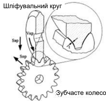
Рисунок 3.25 – Профільне шліфування прямозубого зубчастого колеса високоструктурним кругом
