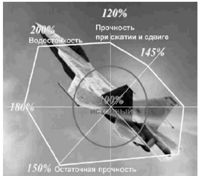
Рисунок 5.22 – Комплексне підвищення механічних й експлуатаційних властивостей конструкційних вуглепластиків, надання їм спеціальних властивостей
