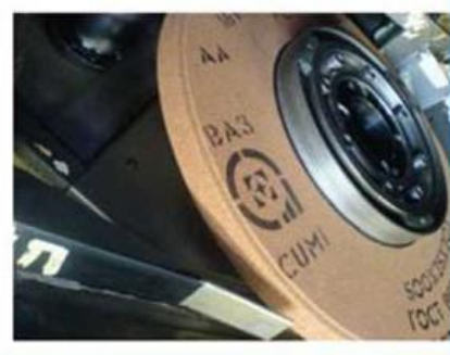
Рисунок 3.23 – Схема двостороннього профільного глибинного шліфування “ялинкового” профілю хвостовика лопатки турбіни авіаційного двигуна й високоструктурний шліфувальний круг
