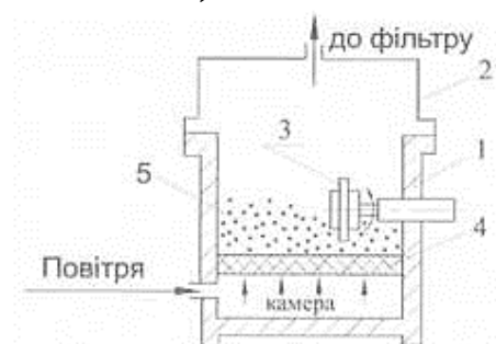
Рисунок 4.19 – Схема турбоабразивної обробки: 1 – корпус установки; 2 – кришка; 3 – оброблювана деталь; 4 – розподільна решітка; 5 – киплячий шар абразивних зерен
