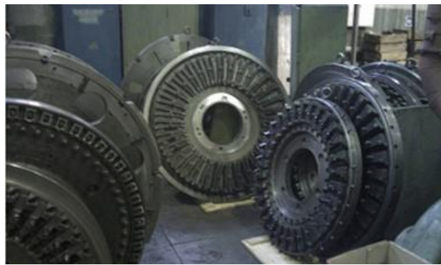
Рисунок 3.17 – роторний пристрій для установки лопаток
