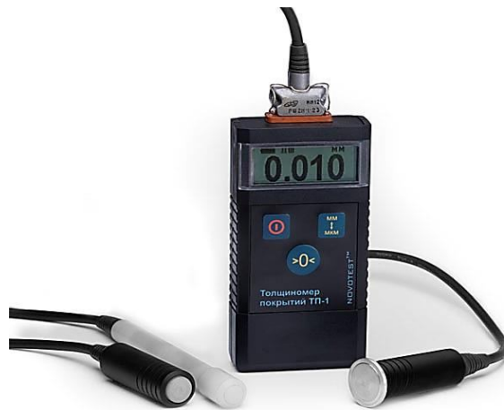
Рисунок 2.8. Товщиномір покриття NOVOTEST ТП-1 (L)
