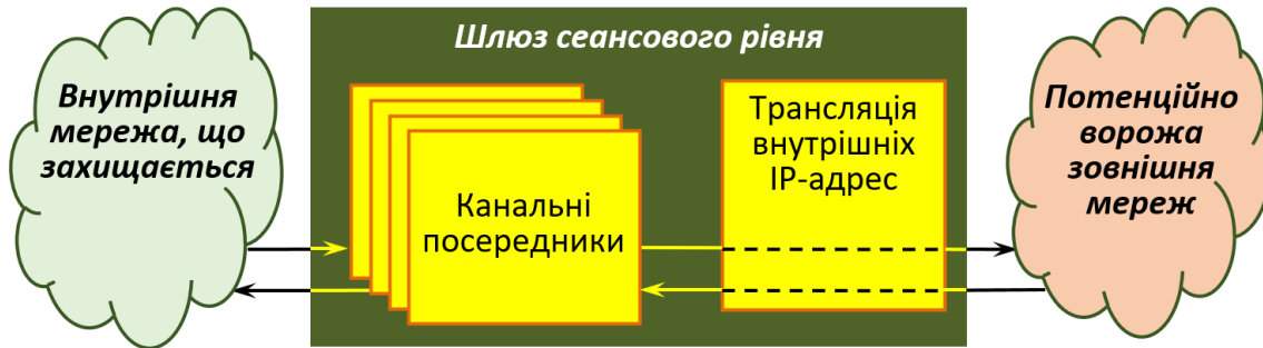
Рисунок 4.6. Схема функціонування шлюзу сеансового рівня
