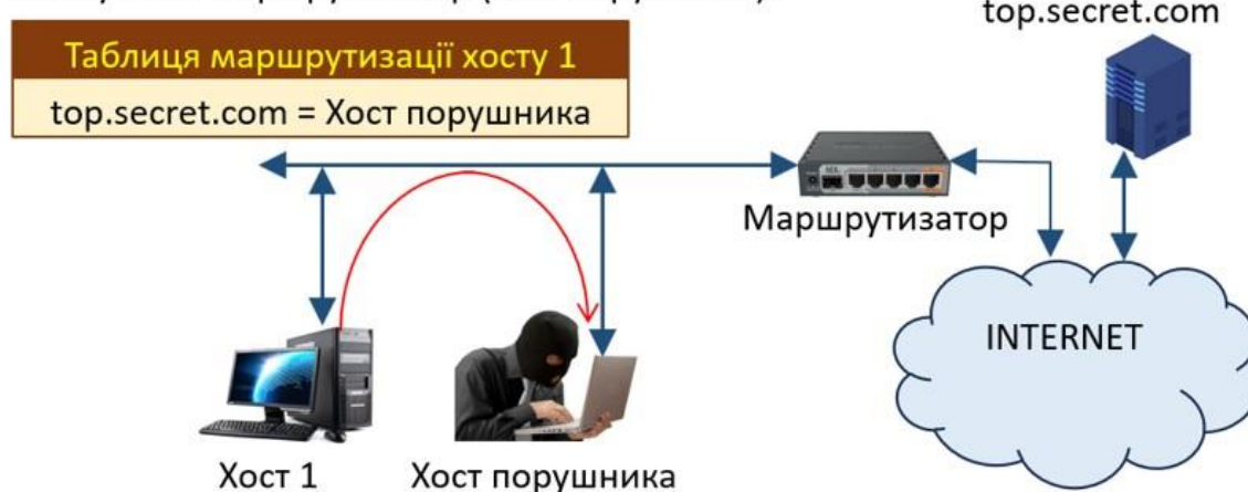
Рисунок 2.4. Нав'язування хосту неправдивого маршруту з використанням протоколу ICMP
