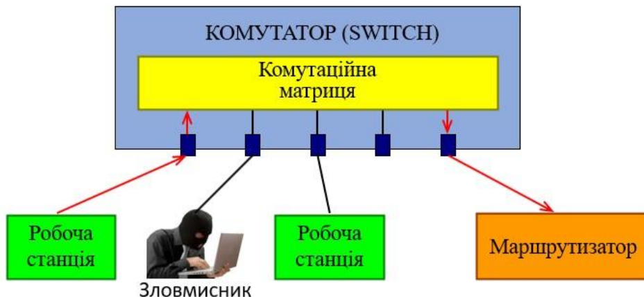
Рисунок 1.10. Зловмисник і об'єкти атаки в одному сегменті другого рівня (але у різних фізичних сегментах – на різних портах комутатора)
