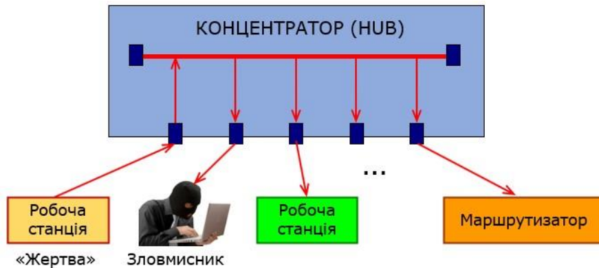
Рисунок 1.9. Зловмисник в одному фізичному сегменті з об'єктами атаки (робочими станціями, маршрутизатором)
