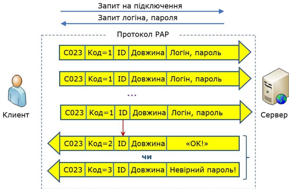
Рисунок 7.8. Послідовність обміну пакетами під час роботи протоколу PAP
