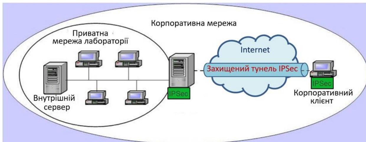
Рисунок 5.11. Схема захисту «шлюз-хост»
