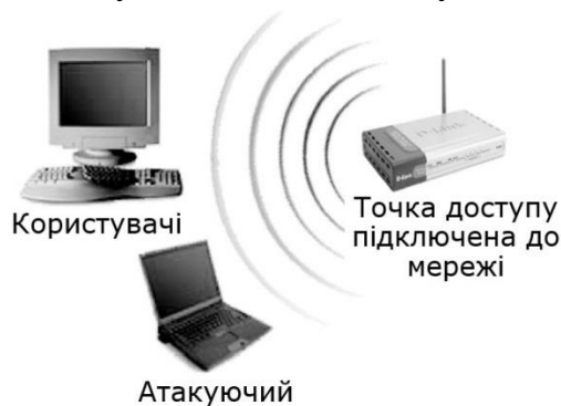
Рисунок 1.12. Прослуховування зловмисником радіохвиль між точкою доступу та користувачами мережі
