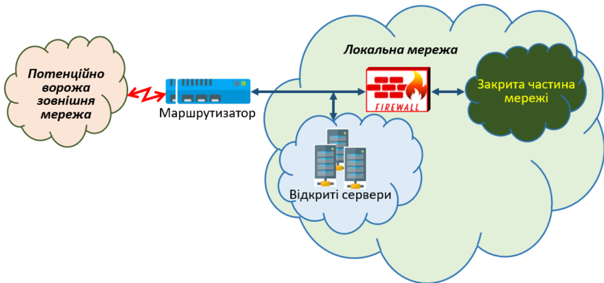
Рисунок 4.10. Схема з закритою і відкритою, що не захищається підмережами
