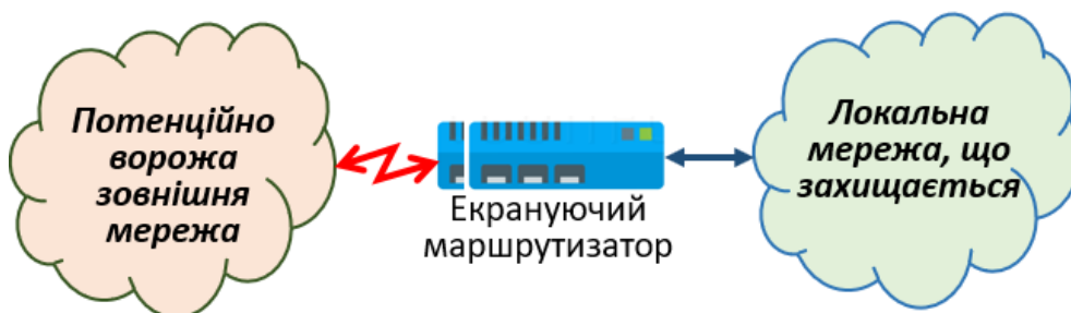
Рисунок 4.8. Схема захисту мережі з використанням екрануючого маршрутизатора
