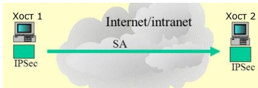
Рисунок 5.9. Схема захисту «хост-хост»
