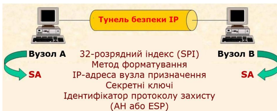
Рисунок 5.6. Асоціація безпеки (SA) та тунель безпеки IP
