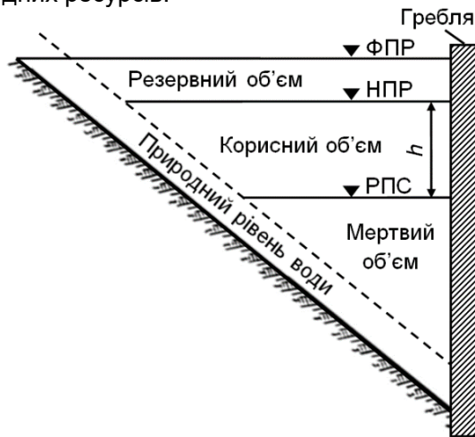
Рис. 7.1. Морфометричні елементи водосховища
