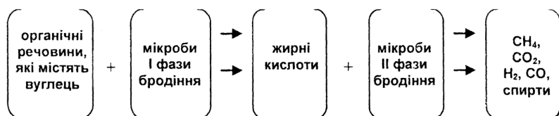
Рис. 4.3. Схематичне відображення процесу збродження ОСВ
