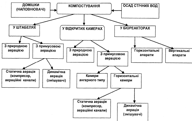
Рис. 6.1. Схема різних методів компостування осадів стічних вод
