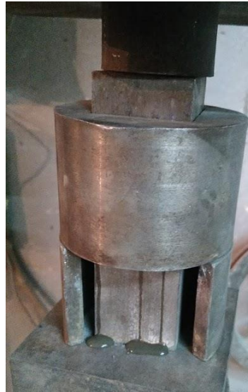
Рис. 1. Прес гідравлічний лабораторний із набором пристосувань для формування зразків методом напівсухого пресування – НП
