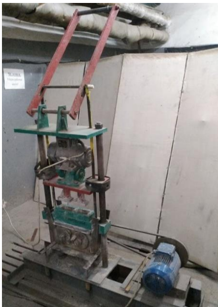
Рис. 2. Прес вібраційний для формування зразків методом вібропресування – ВП
