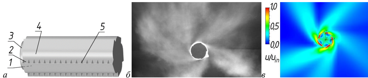
Рис. 1. Повітророзподільник ежекційний тангенціальний (ПЕТ): а – загальний вигляд; б – візуалізація струмини; в – k-ε моделювання (швидкість повітря u , м/с, віднесена до швидкості виходу повітря зі щілини u_{in} , м/с): 1 – плоский вихідний канал завглибишки не менше подвійної ширини; 2 – повітровипускна щілина (5 шт.); 3 – вхідний патрубок; 4 – поверхня настилання; 5 – напрямна пластина
