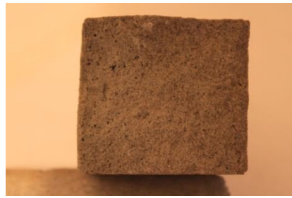
Рис. 3. Ступінь насичення зразків з дрібнозернистого бетону рідким натрієвим склом при створенні внутрішнього вакууму і без нього: а) капілярна просочення ( t = 10 хв), без евакуації зразка; б) просочення ( t = 10 хв), з попереднім вакуумним ущільненням зразка. а) капілярна просочення ( t = 10 хв), без евакуації зразка; б) просочення ( t = 10 хв), з попереднім вакуумним ущільненням зразка.
