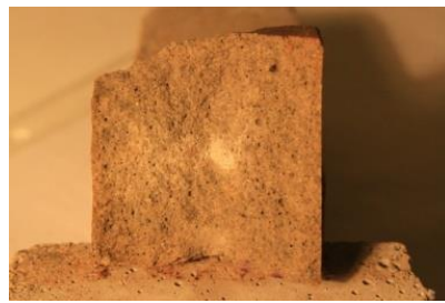
Рис. 4. Ступінь насичення зразків з дрібнозернистого бетону рідким натрієвим склом у різний час просочення: а) просочення ( t = 5 хв), з попереднім вакуумним ущільненням зразка; б) просочення ( t = 7 хв), з попереднім вакуумним ущільненням зразка.
