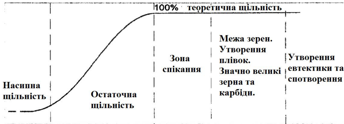
Рисунок 1 - Загальна характеристика процесу спікання швидкорізальних порошкових сталей в інтервалі температур солідус-ліквідус (залежність щільності від температури спікання).
