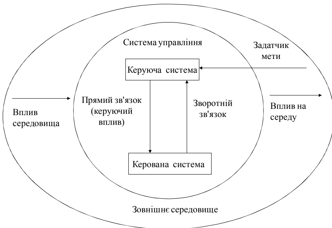
Рисунок 2.2 – Найпростіший контур управління системою
