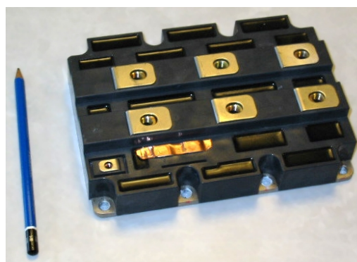
Рисунок 7.20 – Умовно-графічне позначенні IGBT транзистору (а) та зовнішній вигляд збірки IGBT для комутації напруги до 3300 В та струму до 1200 А (б)
