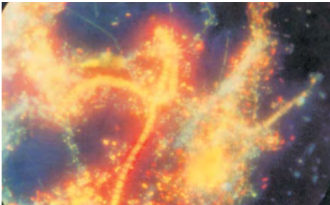
Рис. 15.6. Дефлокуляція пластівців мулу при нитчастому розбуханні
