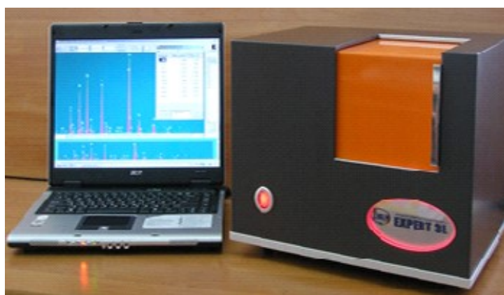
Рисунок 4.6 – Загальний вигляд рентгенофлуоресцентного аналізатора EXPERT 3L
