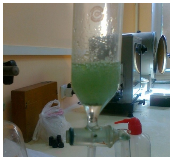
Рисунок 4.4 – Світлина екстрагування ліпідів із синьо-зелених водоростей
