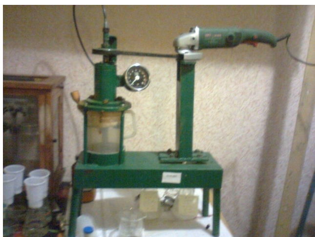
Рисунок 4.3 – Світлина лабораторної робочої установки (кавітатора)
