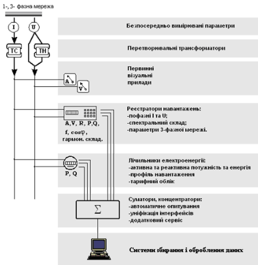
Рис. 8.2. Схема вимірювання параметрів електричної енергії
